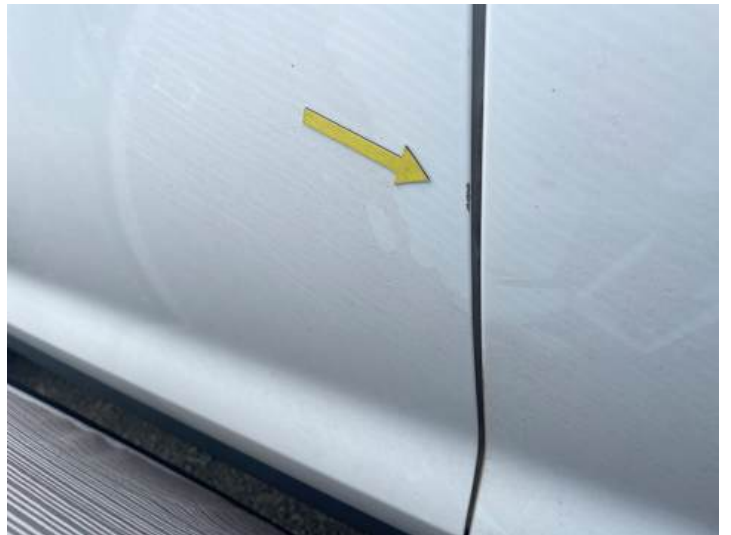
Fahrtür (Delle, Kratzer)
