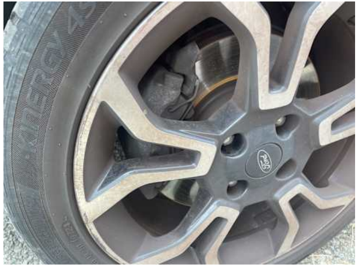
Rad (Kratzer, Ungleichmäßig abgefahren)
