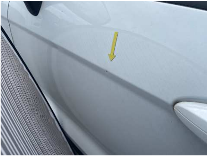
Fahrtür (Delle, Kratzer)
