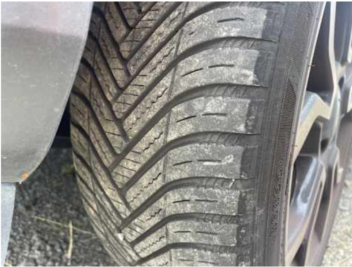
Rad (Kratzer, Ungleichmäßig abgefahren)
