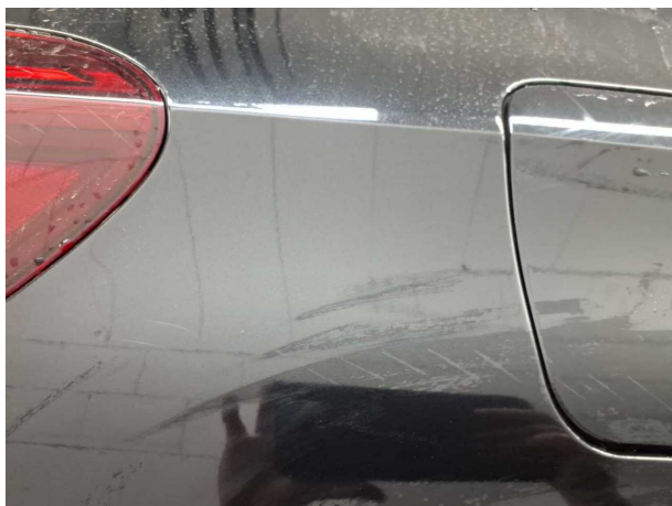
Gebrauchsspur 5: Seitenwand rechts: Seitenwand - Kratzer - auslegen / polieren
