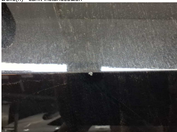
Beschädigung 4: Tür vorn links: Tür (Erschwerter Aufwand) - Delle(n) - sanft instandsetzen
