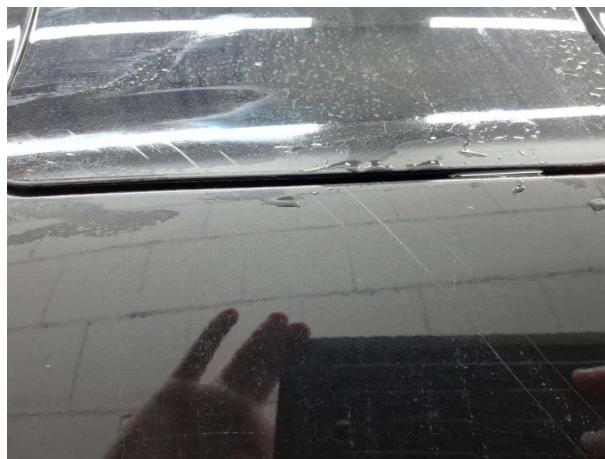
Gebrauchsspur 5: Seitenwand rechts: Seitenwand - Kratzer - auslegen / polieren
