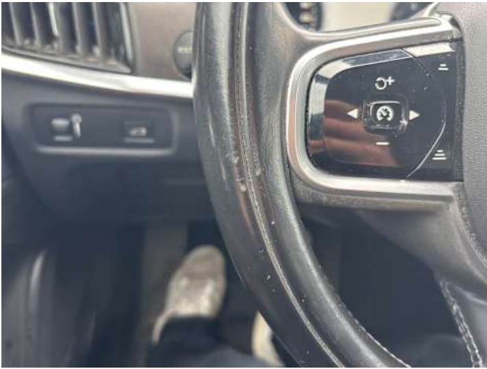
Innenraum (Verschleiß, Kratzer)
