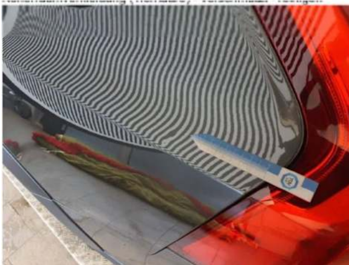
Seitenteil hinten links (Delle)
