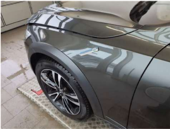
Kotflügel vorne links (Delle)
