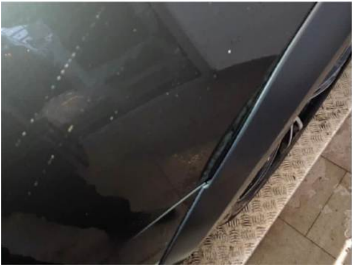
Seitenteil hinten rechts (Spaltmaße ungenau)
