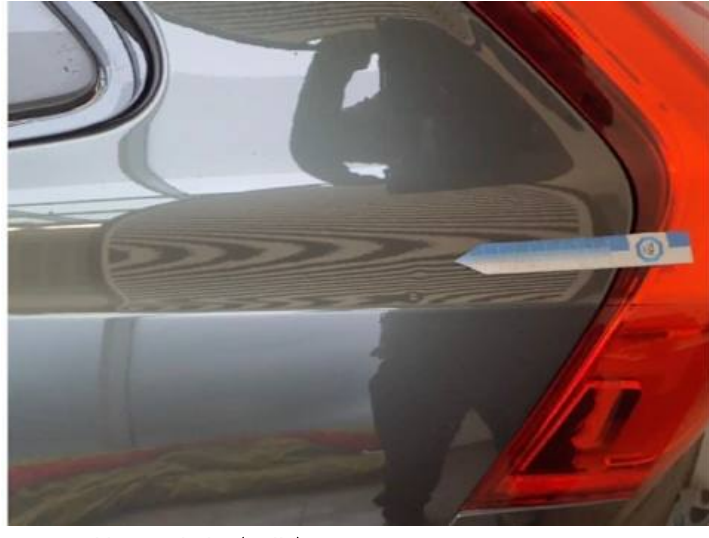
Seitenteil hinten links (Delle)
