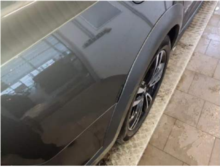
Seitenteil hinten rechts (Spaltmaße ungenau)
