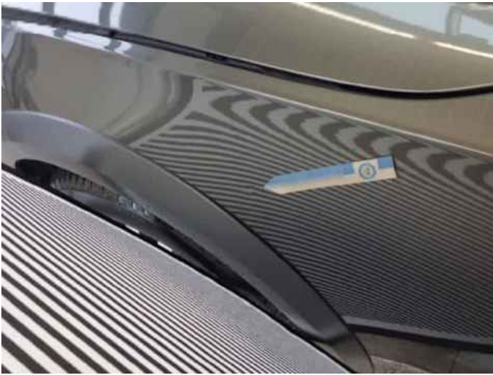
Kotflügel vorne links (Delle)
