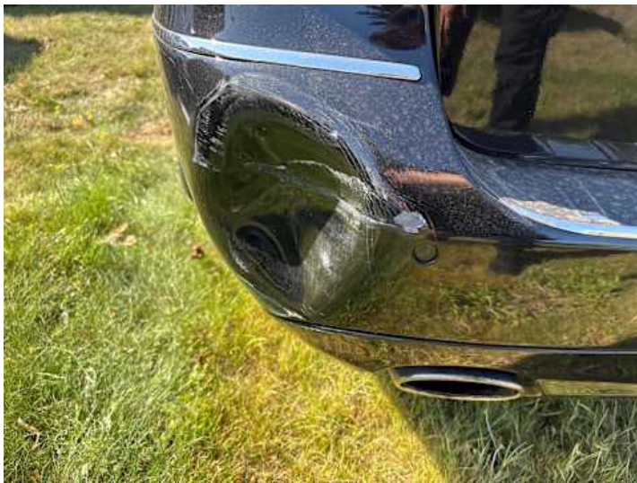
Stoßstange hinten (Lackschaden, Verformung, Kratzer)
