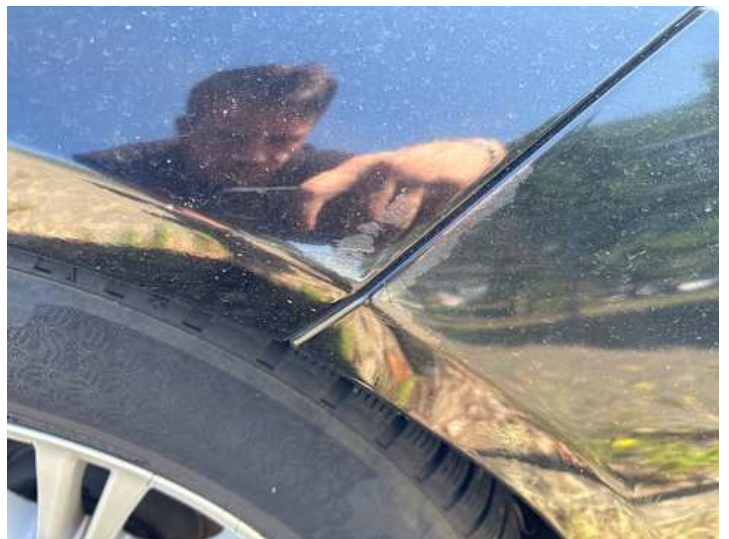
Kotflügel vorne rechts (Unsachgemäß instand gesetzt)
