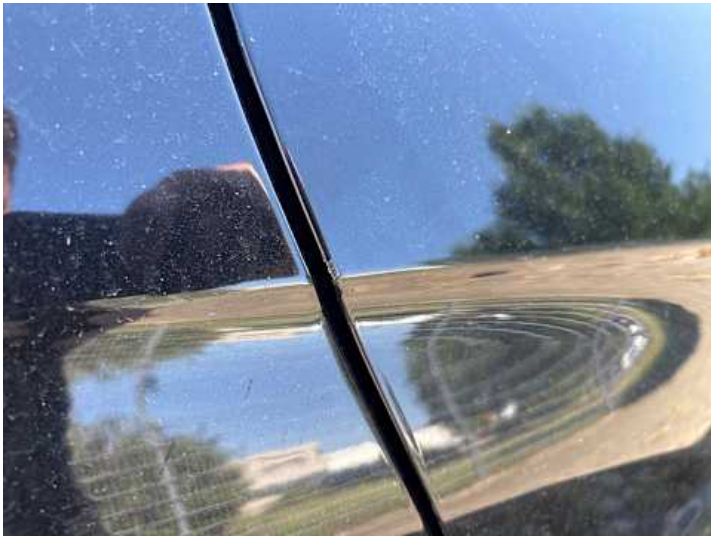
Türe hinten rechts (Lackschaden)
