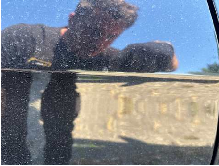
Türe hinten rechts (Lackschaden)
