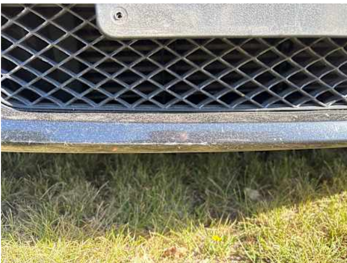
Stoßstange vorne (Lackschaden, Unsachgemäß instand gesetzt, Kratzer)
