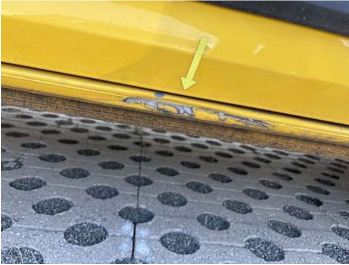
Schweller rechts (Lackschaden, Riss/Bruch)
