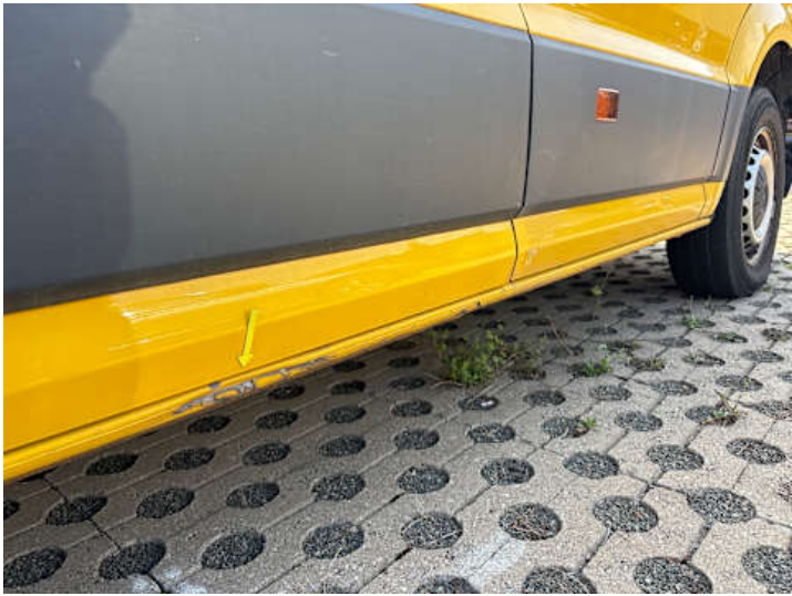
Schweller rechts (Lackschaden, Riss/Bruch)
