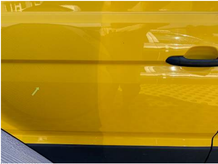
Türe hinten rechts (Delle)
