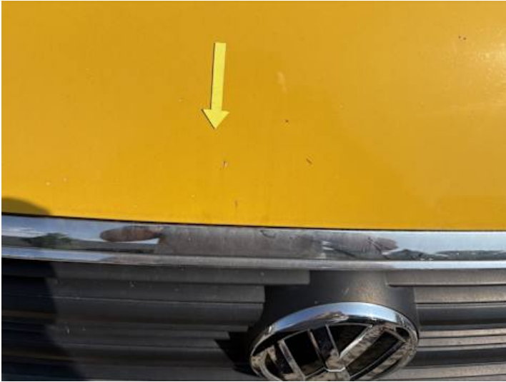
Motorhaube (Steinschlag, Lackschaden)
