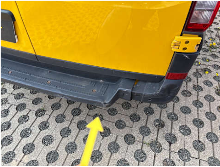
Stoßstange hinten (Verformung, Riss/Bruch, Spaltmaße ungenau)
