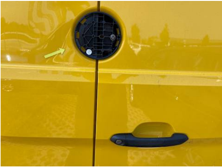
Heckklappe (Anderer Schaden): Bauteil fehlt
