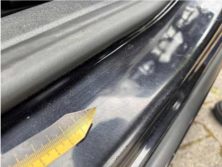
Schweller links (Delle, Kratzer)
