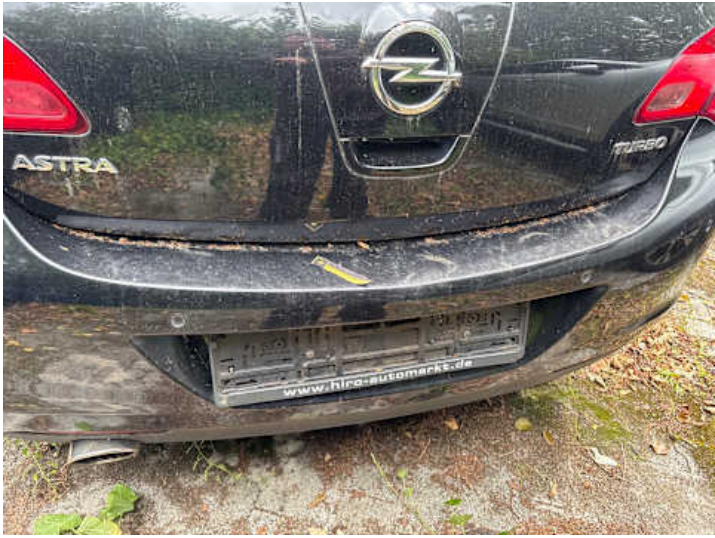
Stoßstange hinten (Kratzer)
