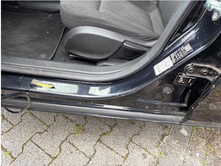
Schweller links (Delle, Kratzer)
