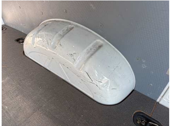
Innenraum (Verschmutzung, Kratzer, Riss/Bruch, Anderer Schaden): Dellen
