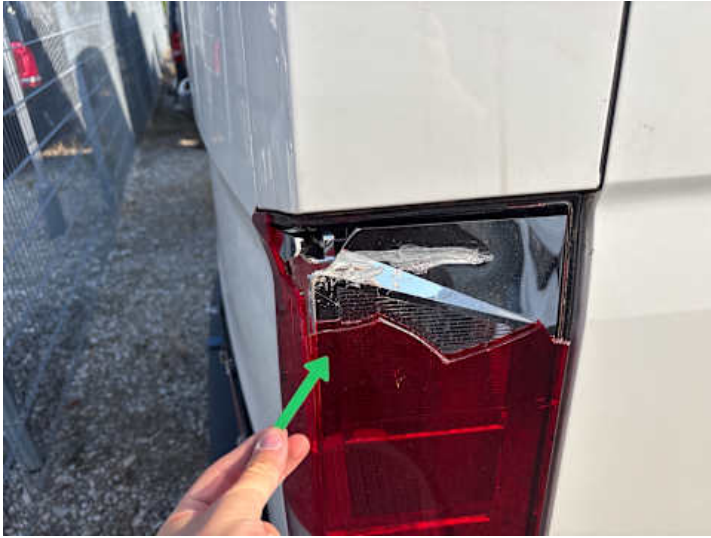
Rücklicht (rechts) (Riss/Bruch)
