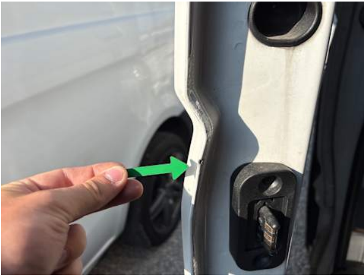
Türe hinten rechts (Lackschaden)
