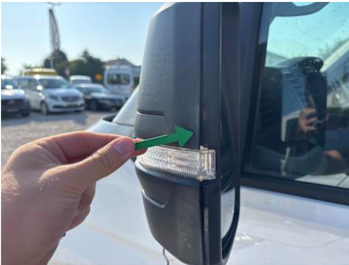
Fahrertür (Kratzer, Anderer Schaden): Spiegelkappe lose
