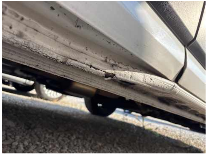
Schweller rechts (Verformung, Lackschaden, Kratzer, Rost)
