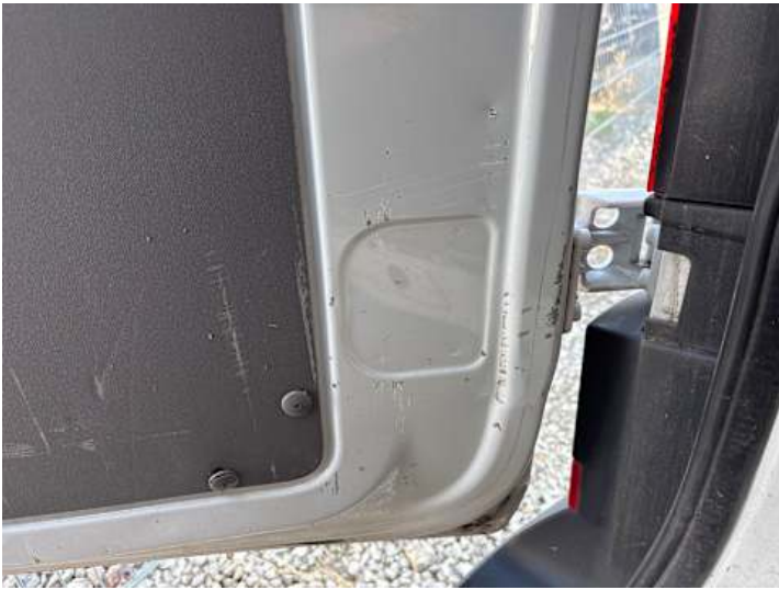
Heckklappe (Delle, Kratzer, Lackschaden)
