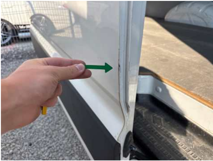
Türe hinten rechts (Lackschaden)
