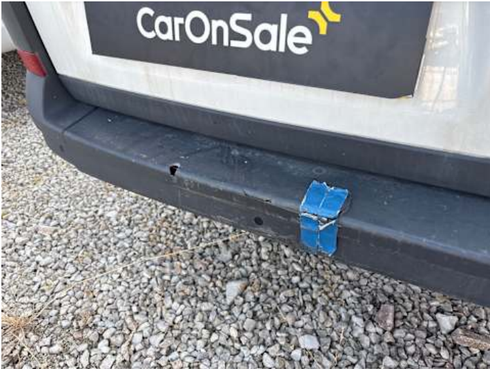
Stoßstange hinten (Kratzer, Riss/Bruch, Verformung)
