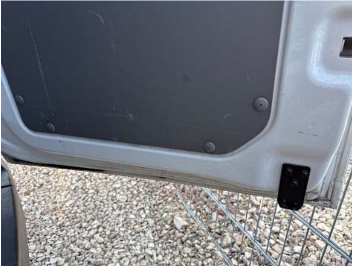
Heckklappe (Delle, Kratzer, Lackschaden)
