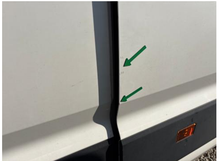
Beifahrertür (Lackschaden, Kratzer)
