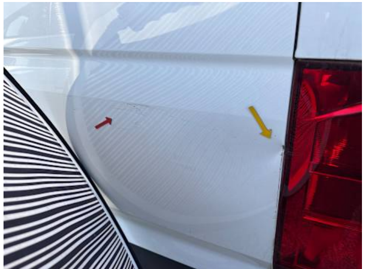
Seitenteil hinten links (Verformung, Kratzer, Lackschaden, Rost)
