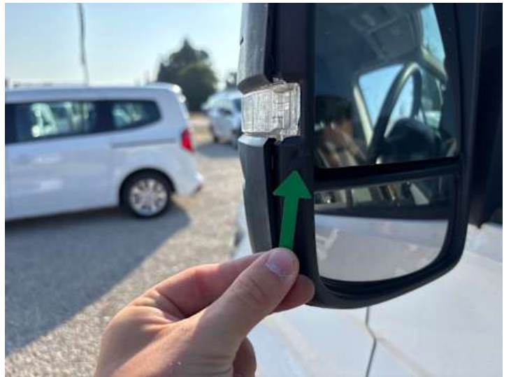
Fahrertür (Kratzer, Anderer Schaden): Spiegelkappe lose
