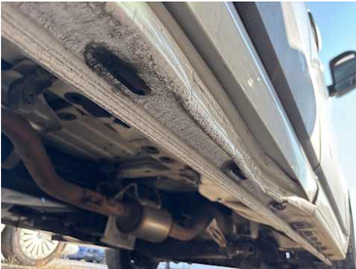
Schweller rechts (Verformung, Lackschaden, Kratzer, Rost)
