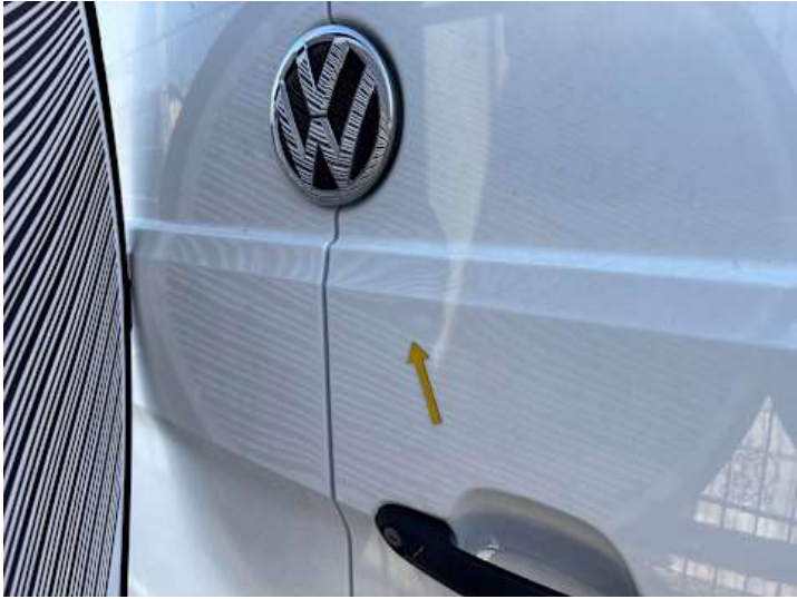
Heckklappe (Delle, Kratzer, Lackschaden)
