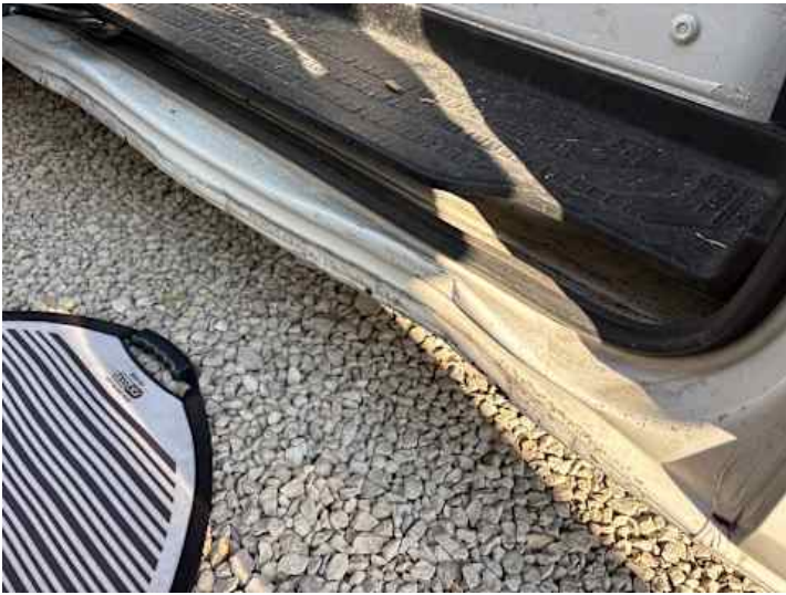
Schweller rechts (Verformung, Lackschaden, Kratzer, Rost)
