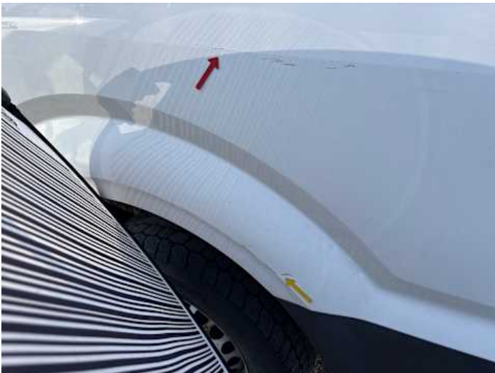
Seitenteil hinten links (Verformung, Kratzer, Lackschaden, Rost)
