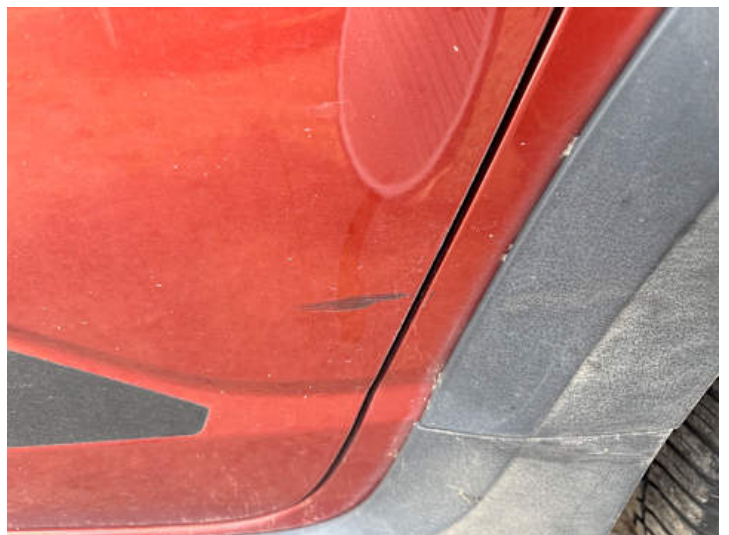
Türe hinten links (Kratzer)
