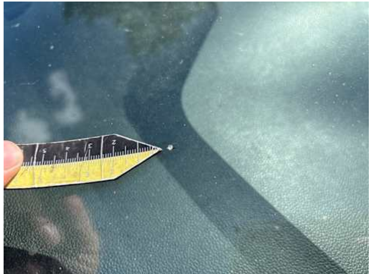
Windschutzscheibe (Riss/Bruch, Steinschlag)
