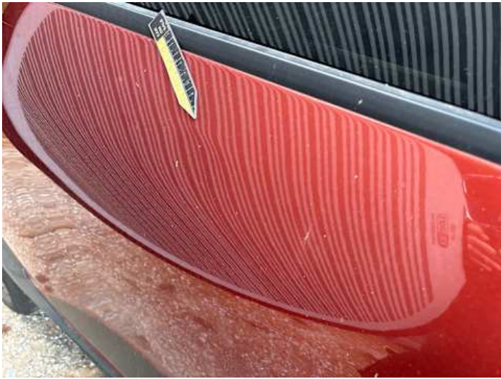
Türe hinten rechts (Delle)
