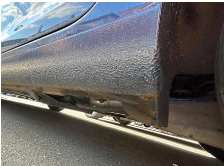
Schweller links (Rost)
