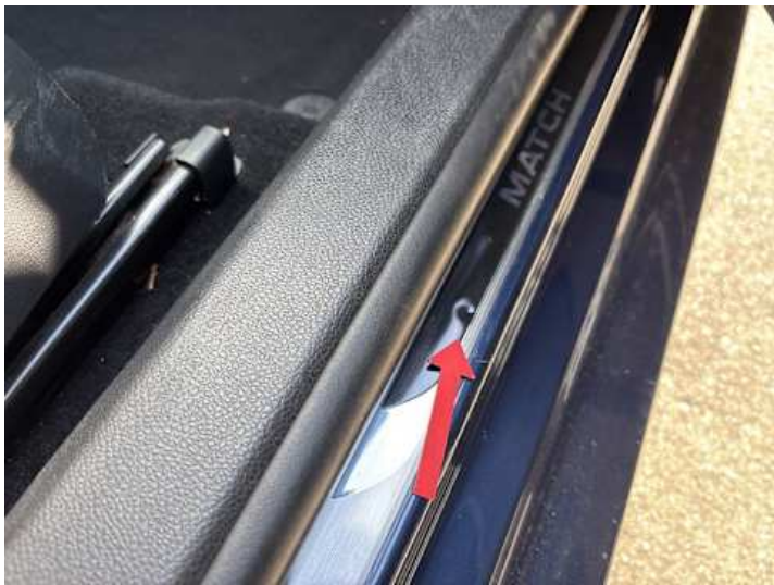
Schweller rechts (Delle)
