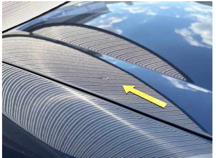
Motorhaube (Delle, Lackschaden)
