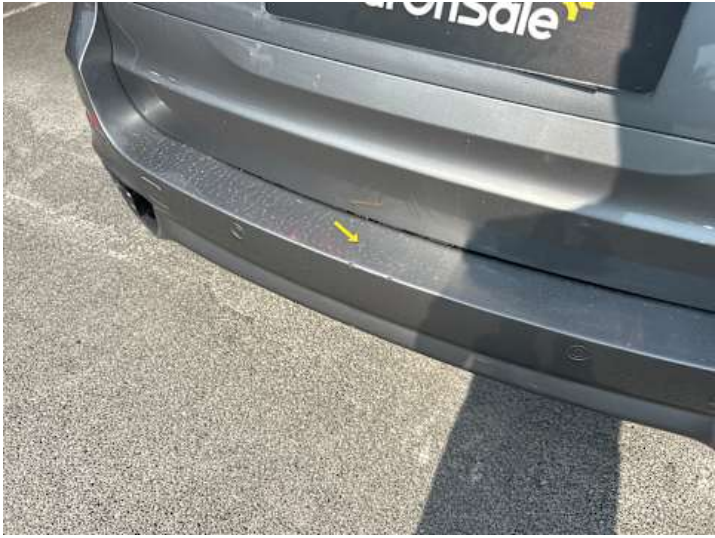
Stoßstange hinten (Kratzer, Verformung)
