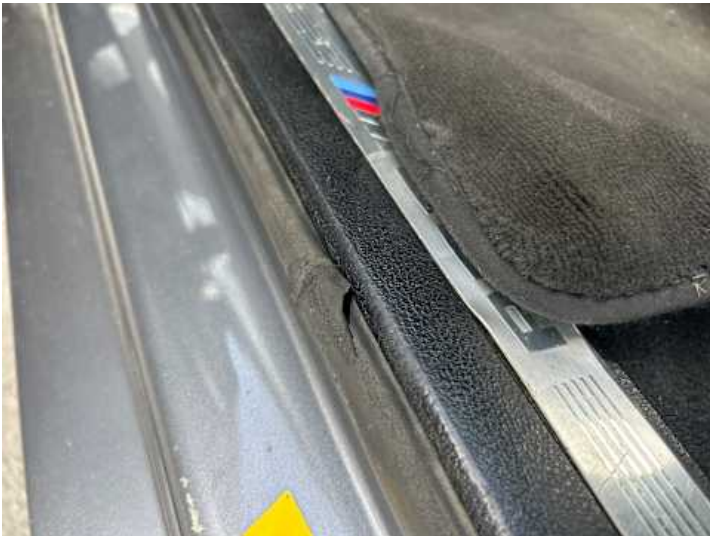
Schweller links (Riss/Bruch)
