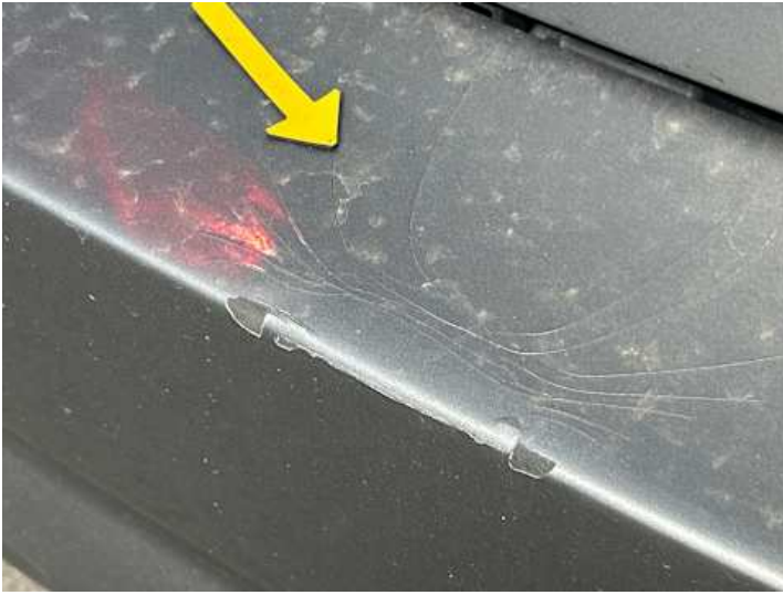
Stoßstange hinten (Kratzer, Verformung)
