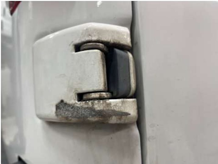
Heckklappe (Kratzer, Lackschaden, Rost)
