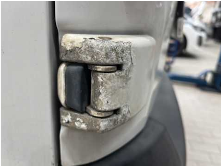
Heckklappe (Kratzer, Lackschaden, Rost)
