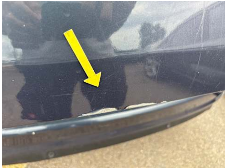
Heckklappe (Lackschaden, Kratzer)
