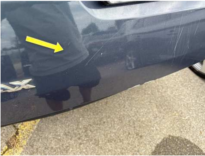
Heckklappe (Lackschaden, Kratzer)
