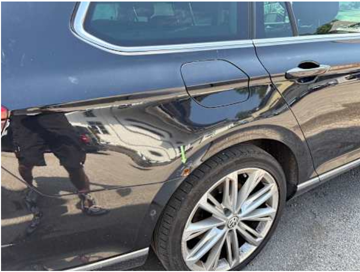
Seitenteil hinten rechts (Rost)
