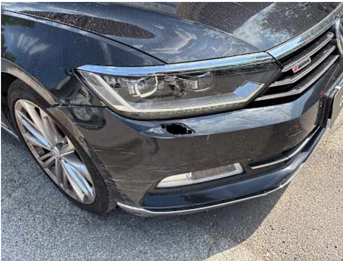
Stoßstange vorne (Riss/Bruch, Spaltmaße ungenau)
