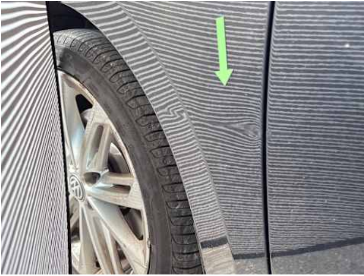
Kotflügel vorne links (Delle, Kratzer)
