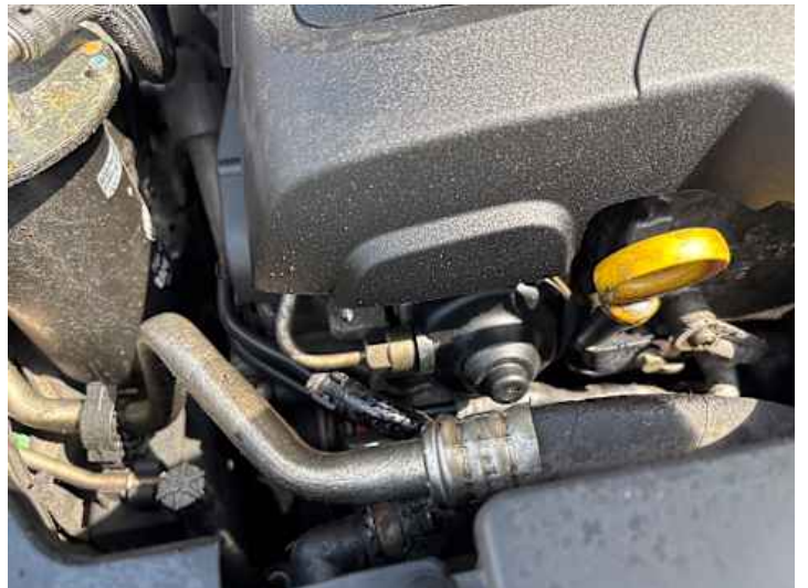
Motorhaube (Anderer Schaden): Ölverlust / Adbluesystem undicht
