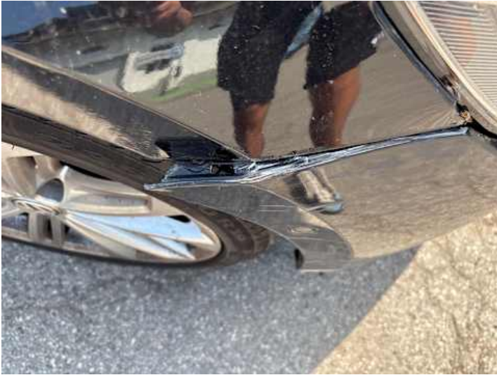
Stoßstange vorne (Riss/Bruch, Spaltmaße ungenau)
