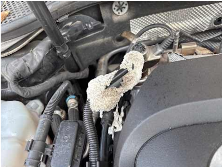
Motorhaube (Anderer Schaden): Ölverlust / Adbluesystem undicht
