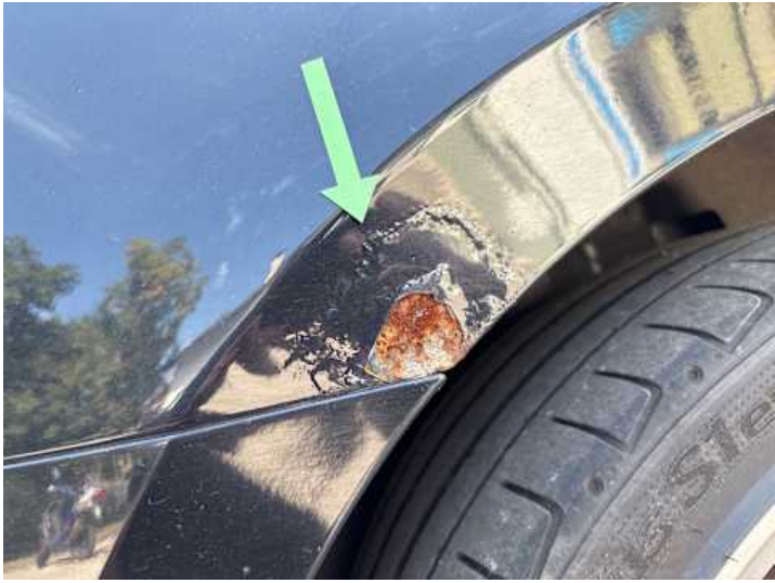
Seitenteil hinten rechts (Rost)
