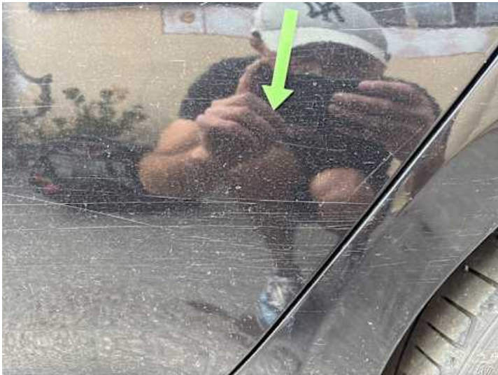
Türe hinten links (Kratzer)
