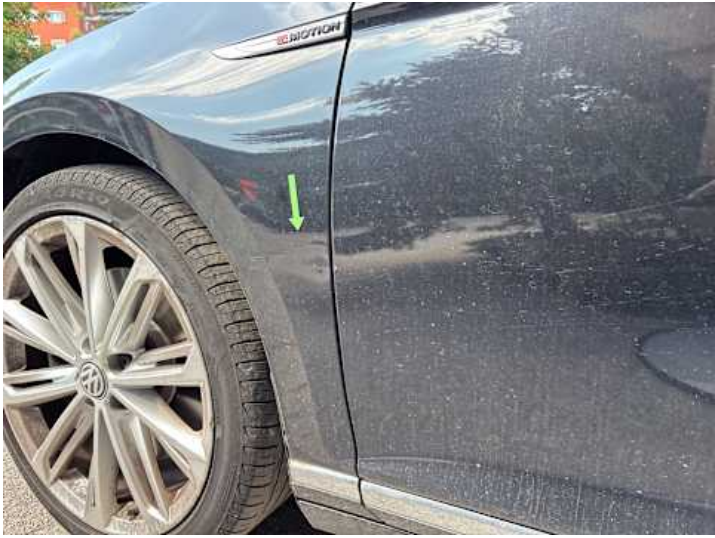
Kotflügel vorne links (Delle, Kratzer)
