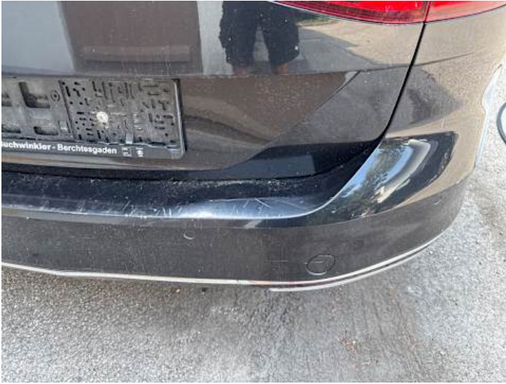
Stoßstange hinten (Riss/Bruch, Verformung)
