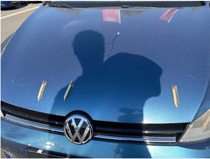
Motorhaube (Steinschlag, Unsachgemäß instand gesetzt)
