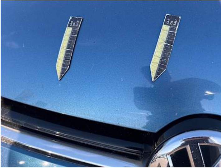
Motorhaube (Steinschlag, Unsachgemäß instand gesetzt)
