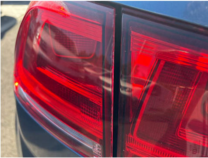
Rücklicht (links) (Riss/Bruch)
