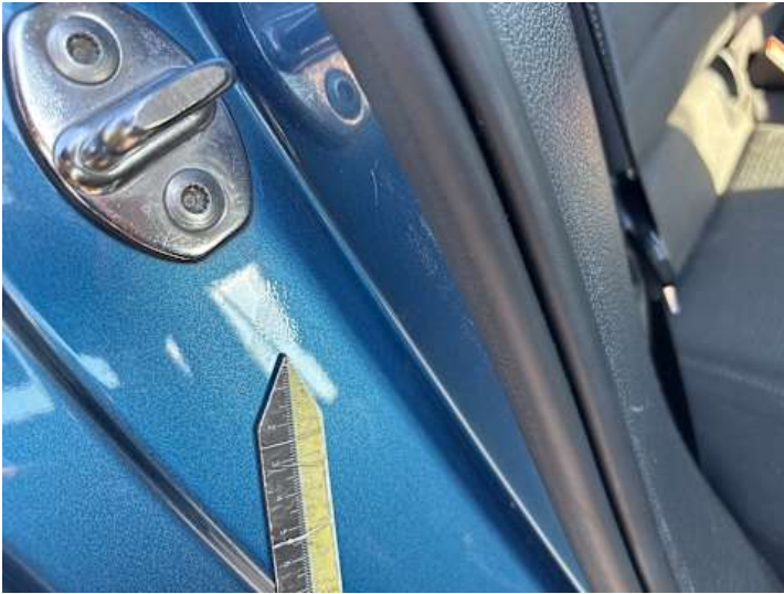
Seitenteil hinten rechts (Lackschaden)
