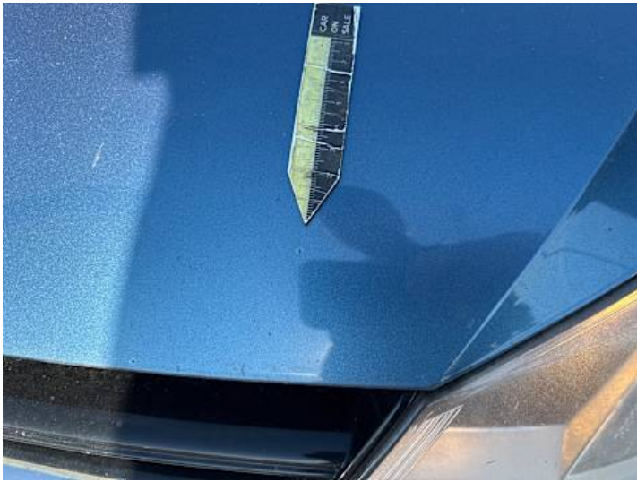
Motorhaube (Steinschlag, Unsachgemäß instand gesetzt)
