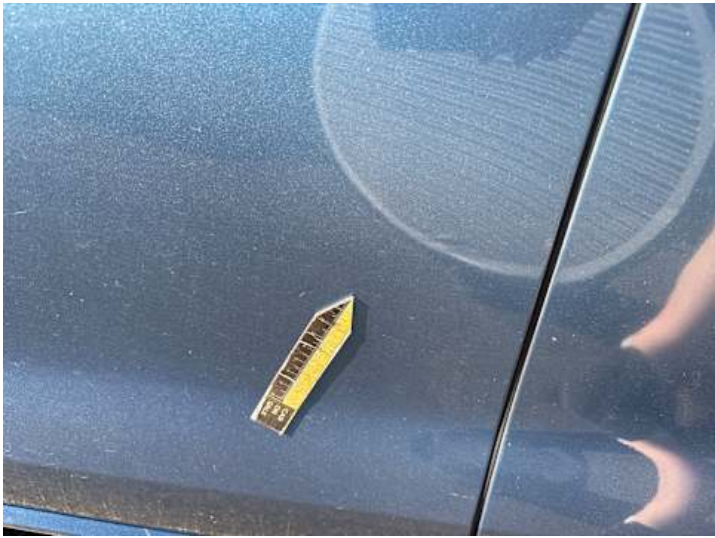
Fahrentür (Verformung, Kratzer)
