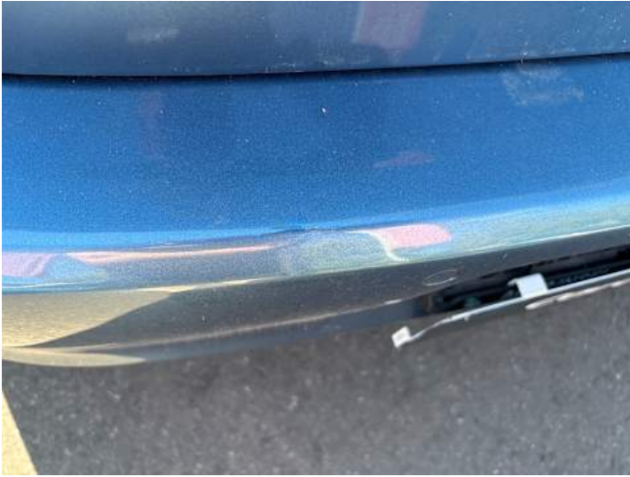
Stoßstange hinten (Riss/Bruch)
