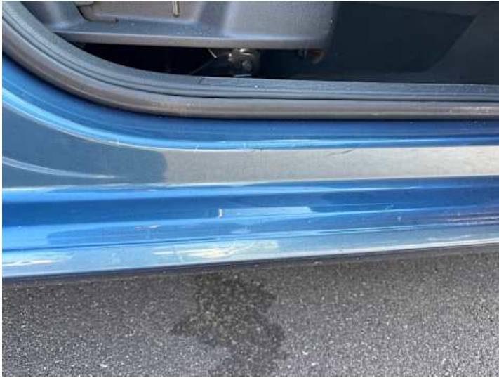
Schweller rechts (Kratzer, Unsachgemäß instand gesetzt)
