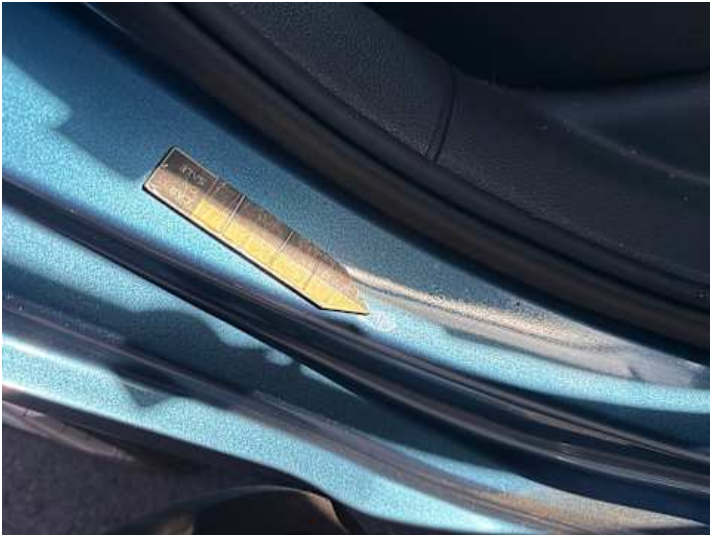
Schweller rechts (Kratzer)
