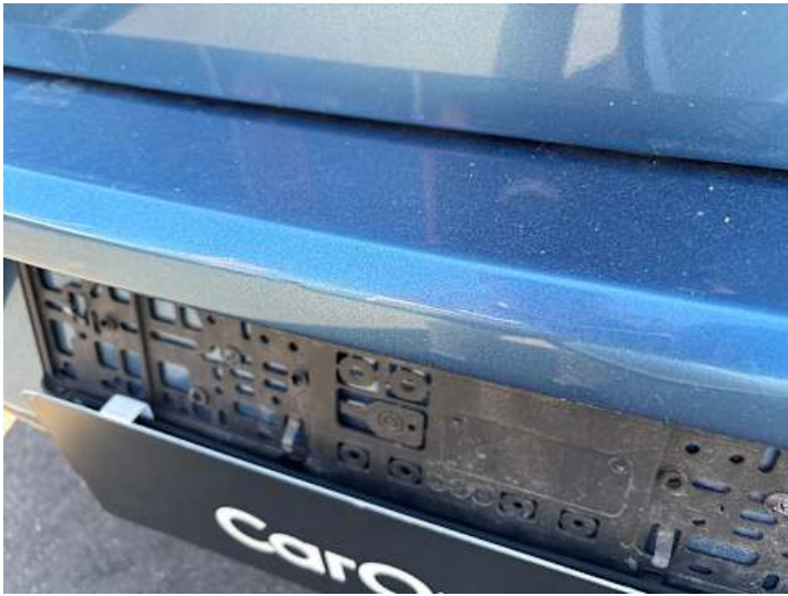
Stoßstange hinten (Riss/Bruch)
