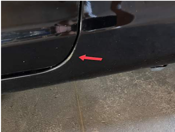
Schweller links (Kratzer, Delle, Rost)
