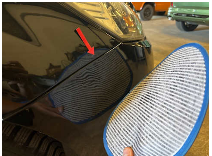
Stoßstange vorne (Verformung)
