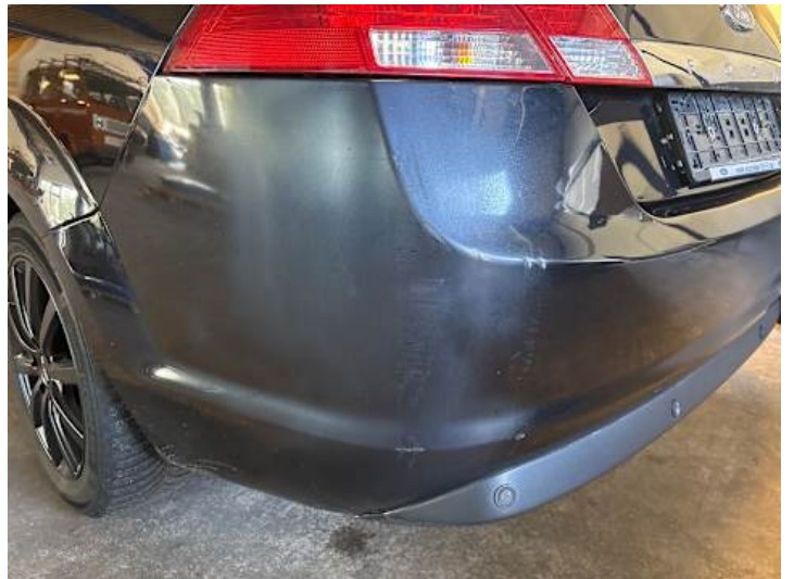
Stoßstange hinten (Unsachgemäß instand gesetzt)
