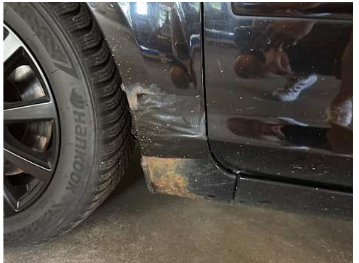
Kotflügel vorne links (Rost)
