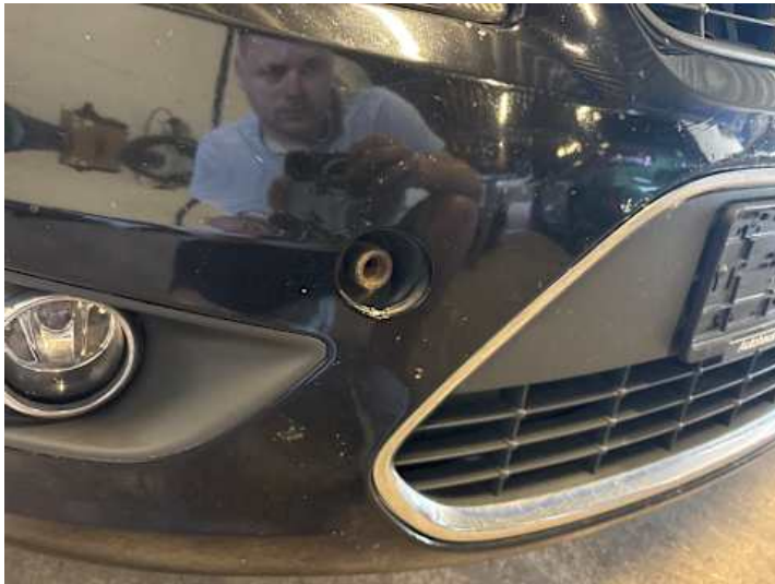
Stoßstange vorne (Anderer Schaden): Kappe fehlt
