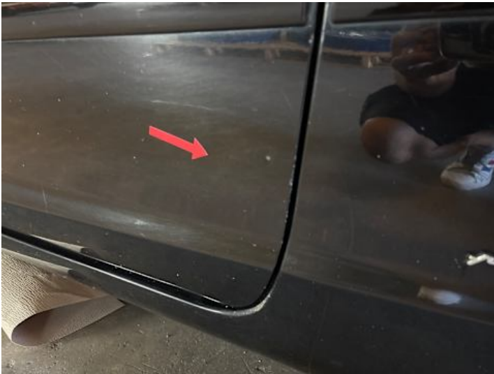
Fahrtür (Kratzer, Delle)
