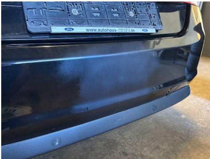
Stoßstange hinten (Unsachgemäß instand gesetzt)
