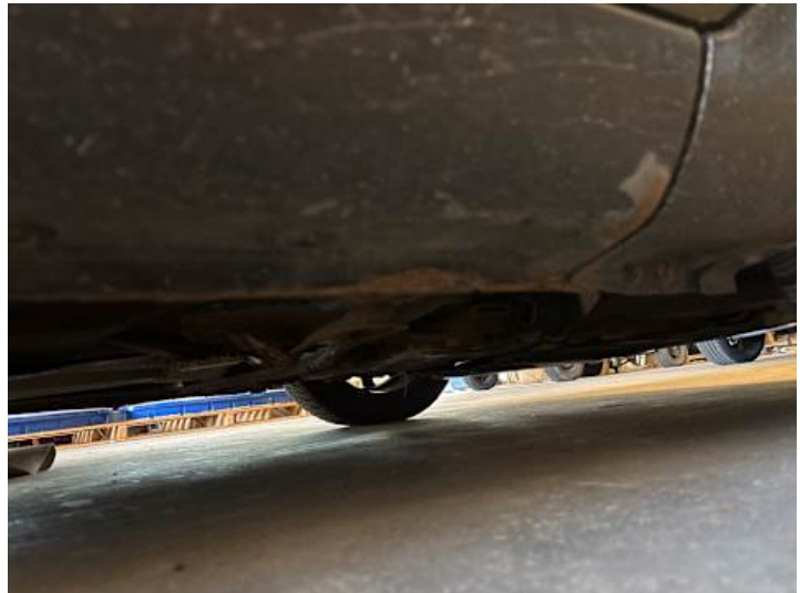
Schweller rechts (Rost, Verformung)
