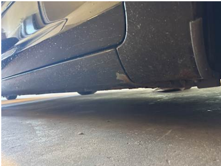
Schweller rechts (Rost, Verformung)
