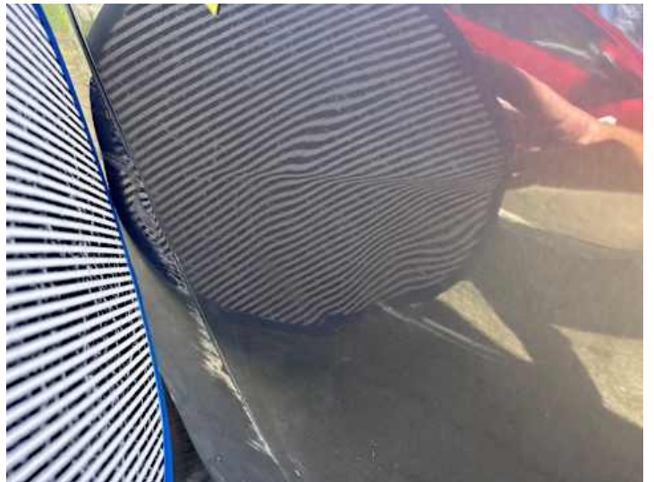
Türe hinten rechts (Kratzer, Verformung)
