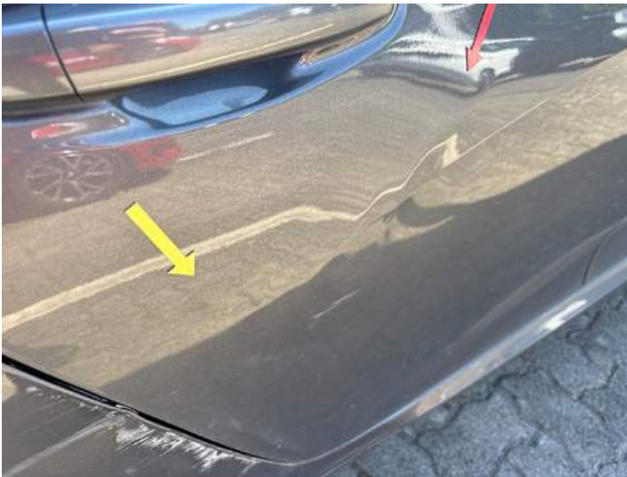
Türe hinten rechts (Kratzer, Verformung)
