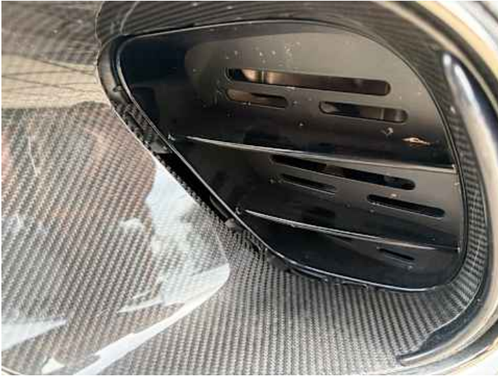
Stoßstange vorne (Anderer Schaden): Blende lose
