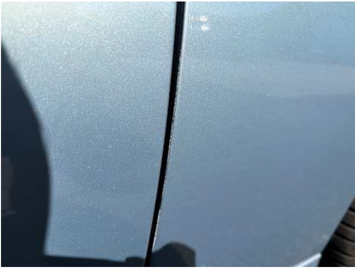
Kotflügel vorne rechts (Lackschaden)
