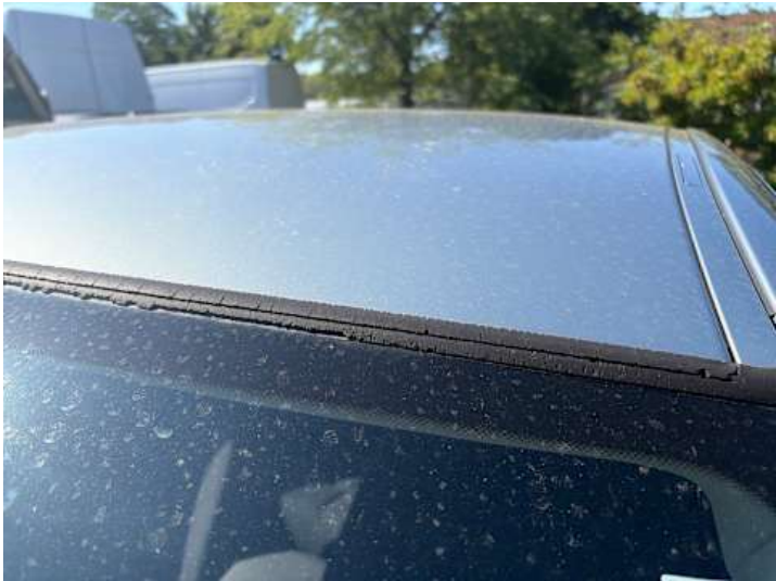
Windschutzscheibe (Anderer Schaden): Dichtung beschädigt
