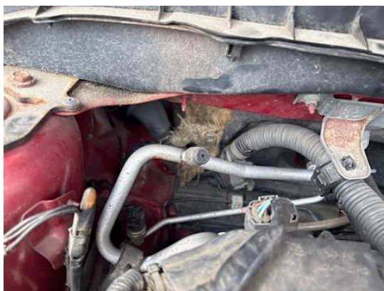
Motorhaube (Anderer Schaden): Dämmmatte beschädigt
