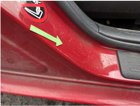
Schweller rechts (Kratzer)
