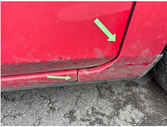
Kotflügel vorne rechts (Spaltmaße ungenau, Anderer Schaden): Lose
