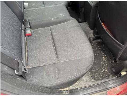
Innenraum (Verschmutzung, Anderer Schaden): Druckstellen
