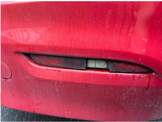
Rücklicht (links) (Riss/Bruch)
