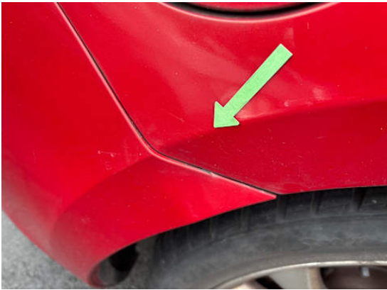
Seitenteil hinten rechts (Verformung, Spaltmaße ungenau)
