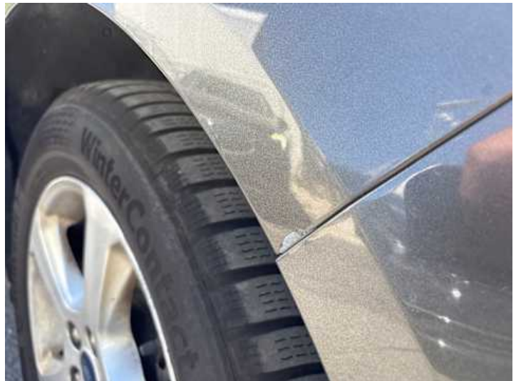
Kotflügel vorne rechts (Lackschaden)
