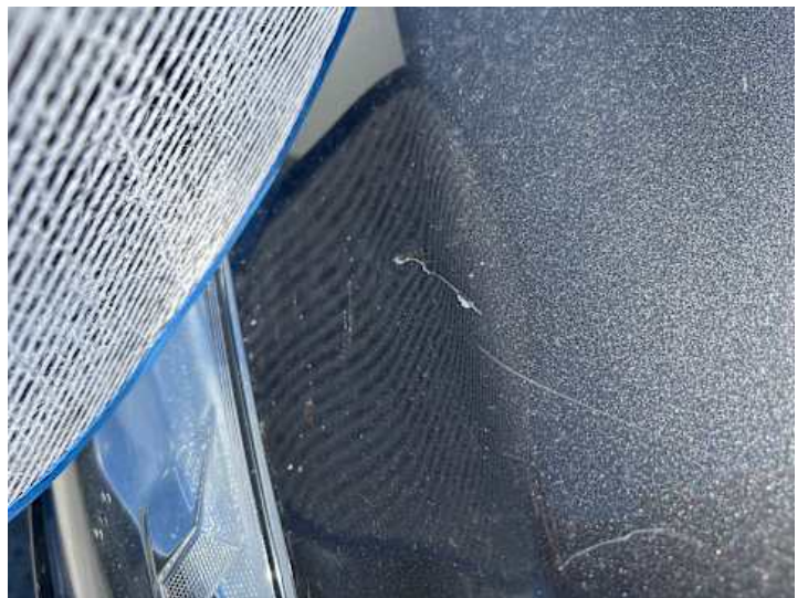
Motorhaube (Lackschaden, Delle)
