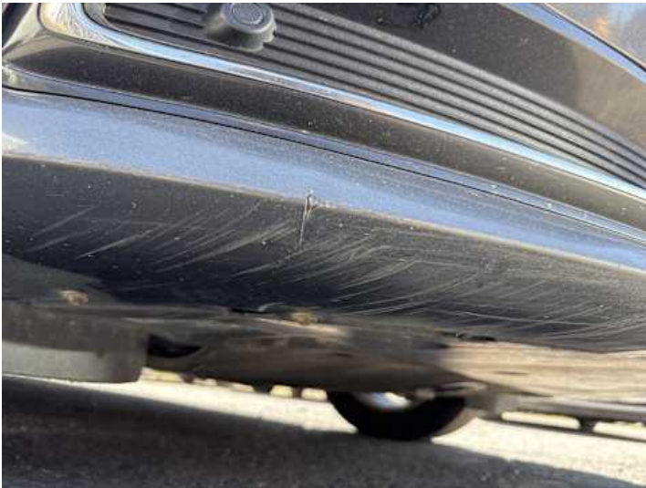
Stoßstange vorne (Kratzer, Lackschaden)
