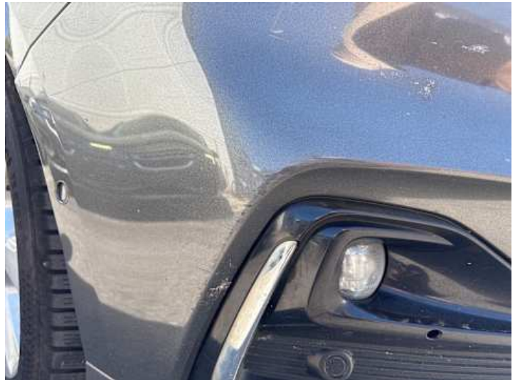
Stoßstange vorne (Kratzer, Lackschaden)
