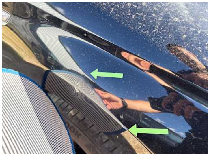
Kotflügel vorne rechts (Kratzer, Delle)
