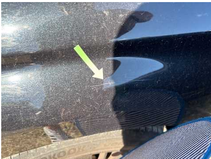
Kotflügel vorne links (Kratzer, Delle)
