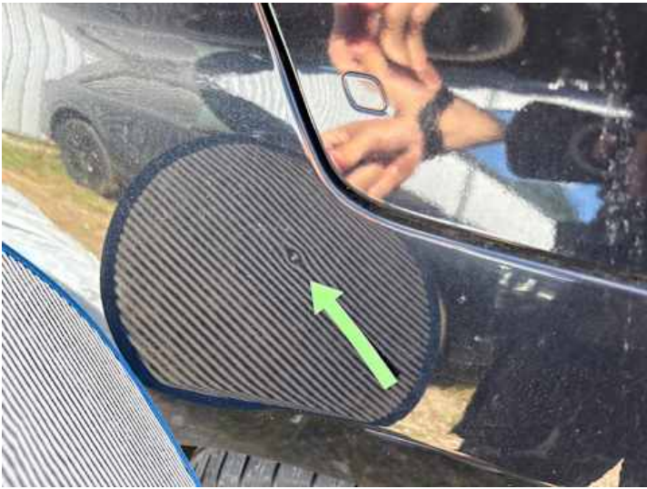
Seitenteil hinten rechts (Kratzer, Delle)
