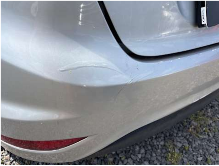
Stoßstange hinten (Kratzer, Verformung, Lackschaden)
