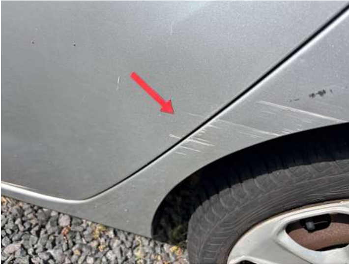
Türe hinten links (Delle, Lackschaden)
