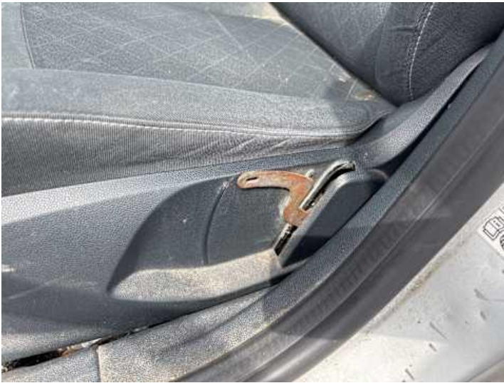
Innenraum (Anderer Schaden): Hebel fehlt,
