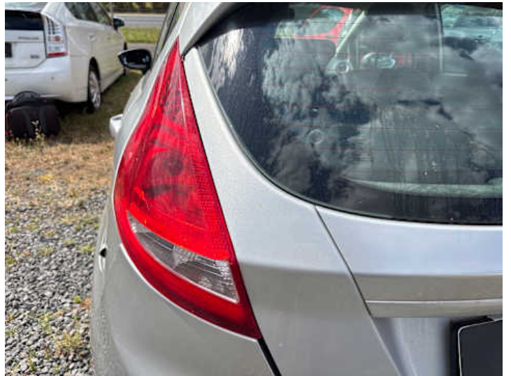
Heckklappe (Spaltmaße ungenau)
