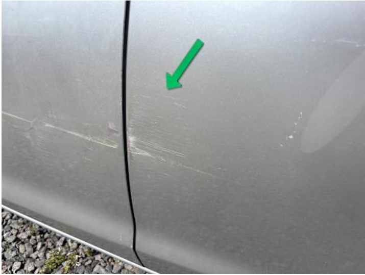
Türe hinten links (Delle, Lackschaden)
