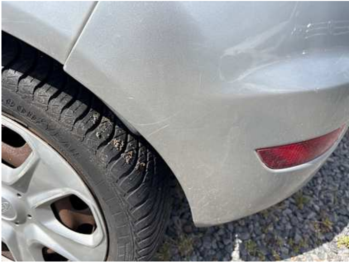
Stoßstange hinten (Kratzer, Verformung, Lackschaden)
