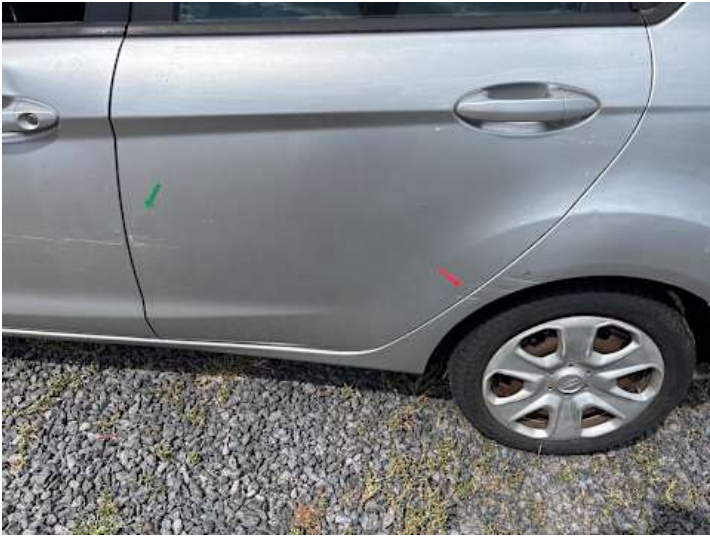
Türe hinten links (Delle, Lackschaden)
