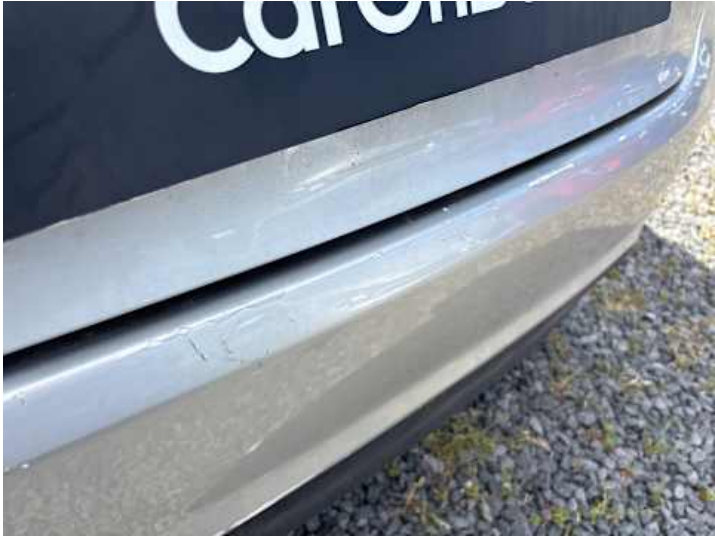
Stoßstange hinten (Kratzer, Verformung, Lackschaden)
