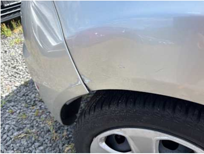
Seitenteil hinten rechts (Delle, Lackschaden, Rost)
