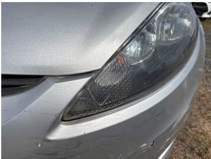
Scheinwerfer (links) (Riss/Bruch)
