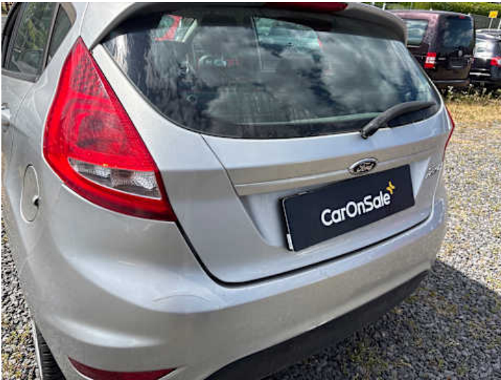
Heckklappe (Spaltmaße ungenau)
