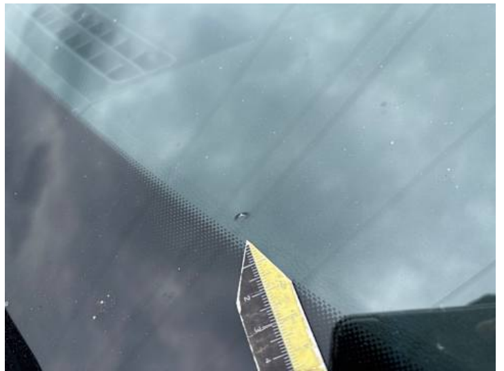
Windschutzscheibe (Steinschlag, Riss/Bruch)
