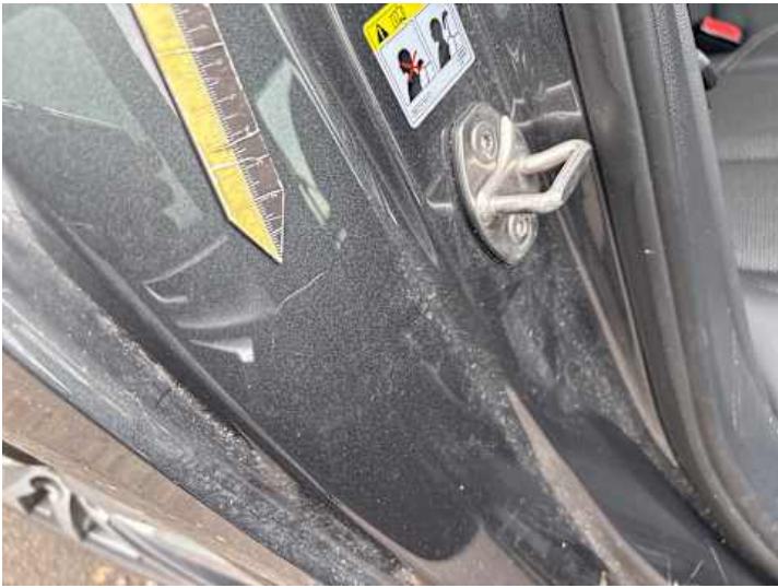
Seitenteil hinten rechts (Kratzer)
