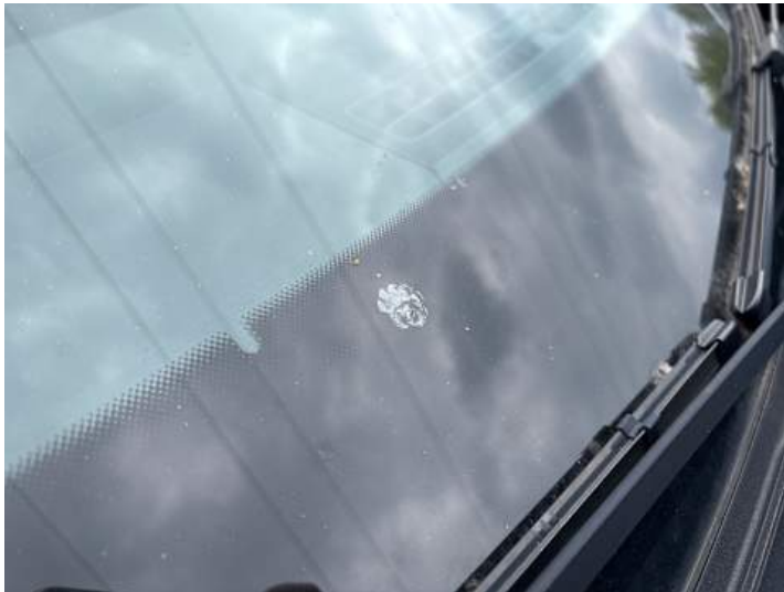
Windschutzscheibe (Steinschlag, Riss/Bruch)
