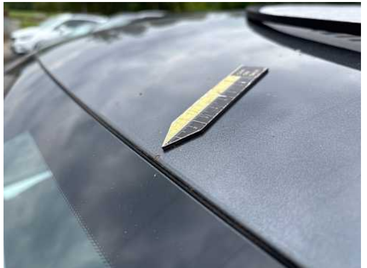
Dach (Steinschlag, Rost)
