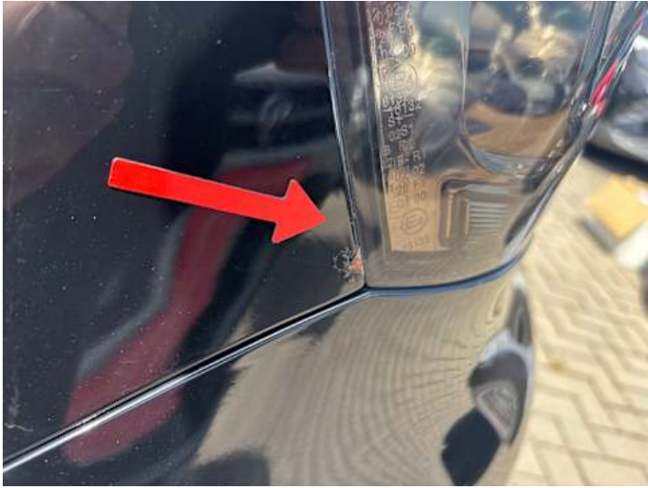
Seitenteil hinten links (Rost, Lackschaden)
