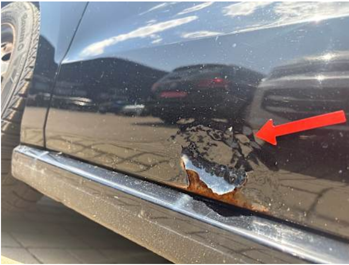
Fahrertür (Lackschaden, Rost)
