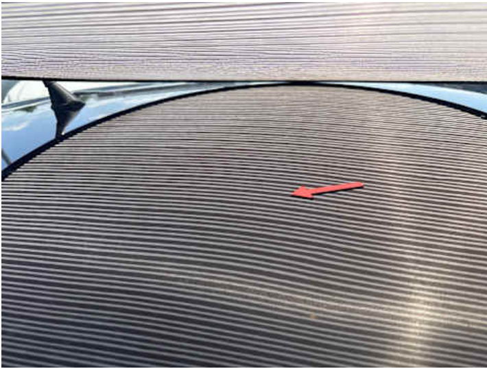
Dach (Delle, Verformung)
