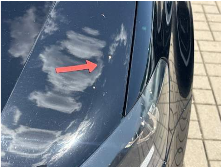
Motorhaube (Steinschlag, Rost)
