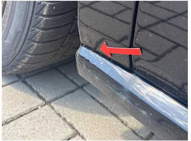
Schweller links (Rost)
