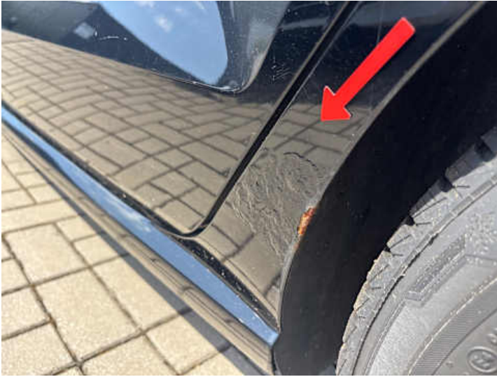
Seitenteil hinten links (Rost, Lackschaden)
