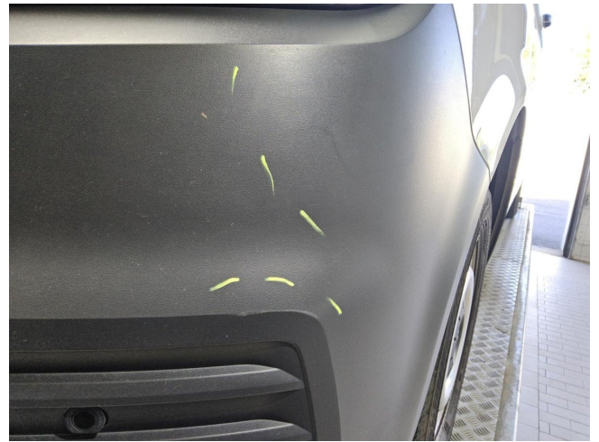
Stoßfänger vorne links Kratzer
