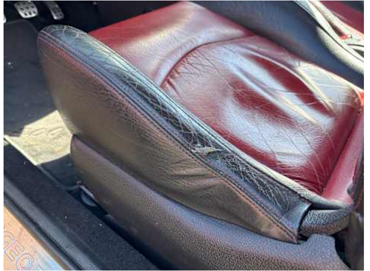
Innenraum (Verschleiß, Riss/Bruch)
