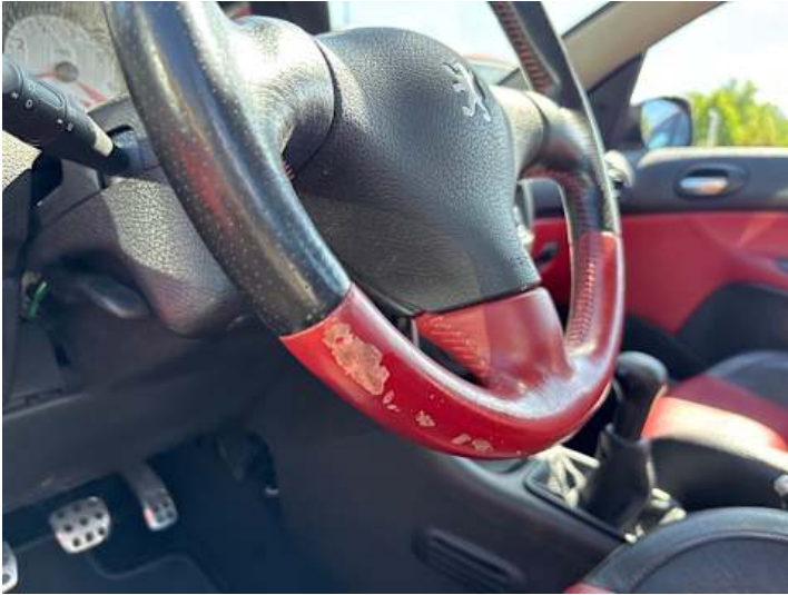
Innenraum (Verschleiß, Riss/Bruch)
