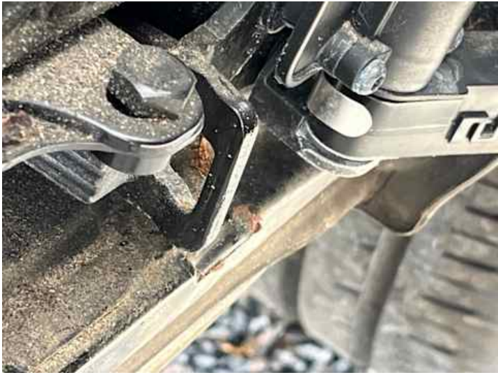
Schweller links (Rost)
