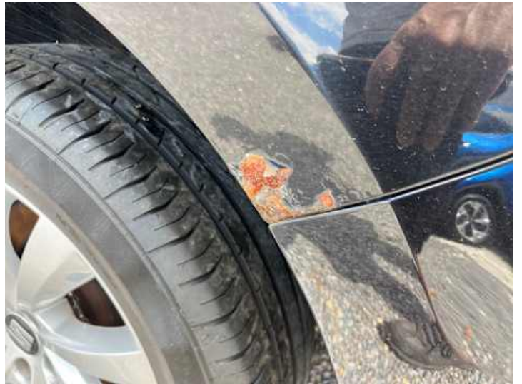
Seitenteil hinten links (Rost)
