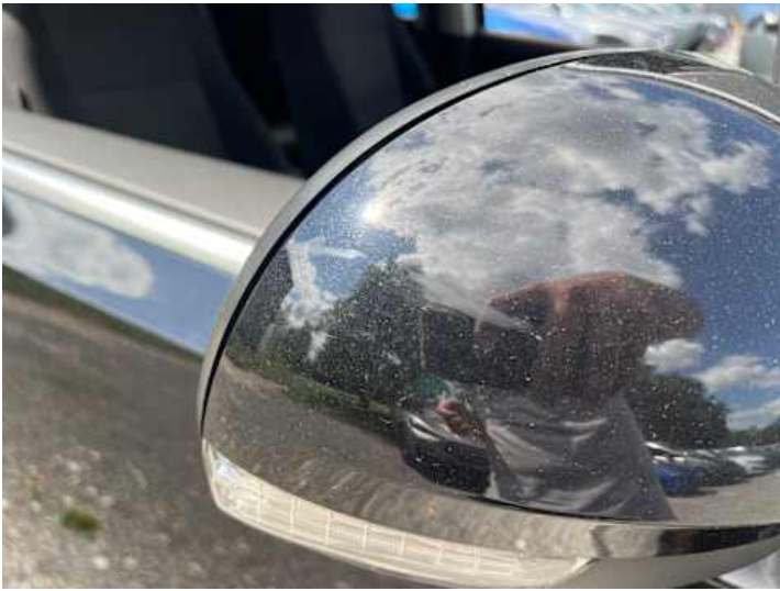
Beifahrertür (Lackschaden, Unsachgemäß instand gesetzt)
