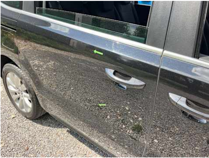
Türe hinten rechts (Lackschaden, Delle)
