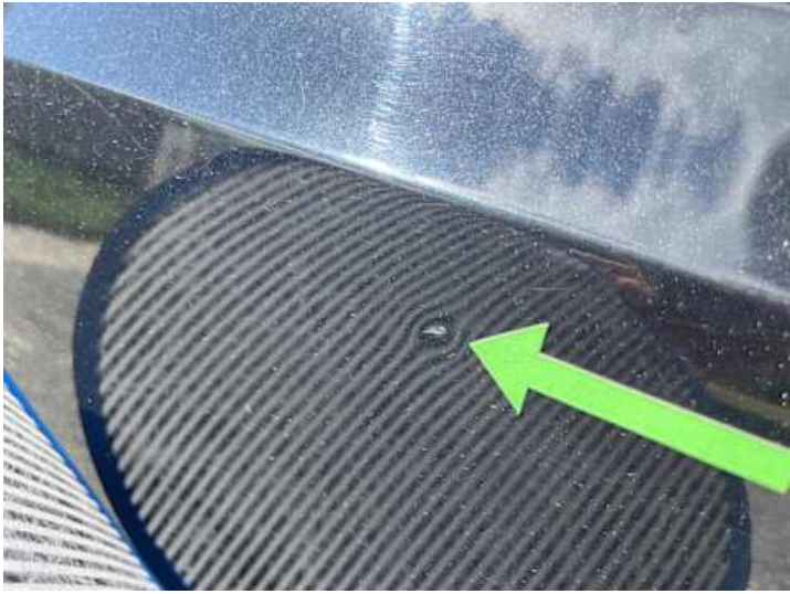
Türe hinten rechts (Lackschaden, Delle)
