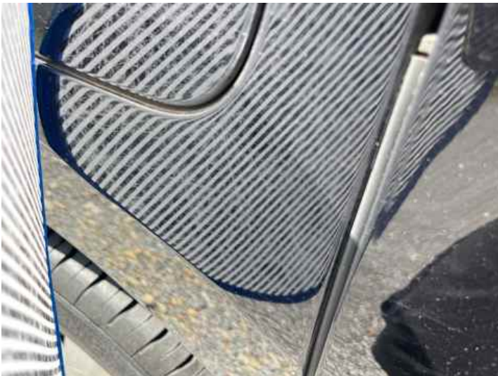
Seitenteil hinten rechts (Unsachgemäß instand gesetzt)
