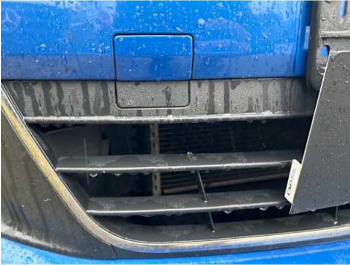
Stoßstange vorne (Riss/Bruch)
