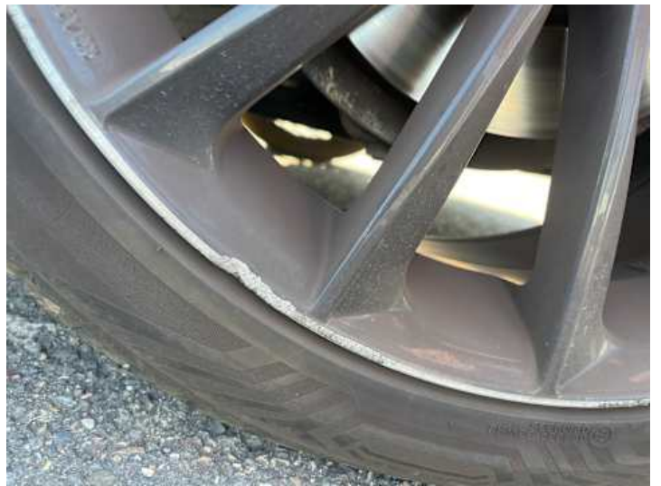
Rad (Kratzer, Anderer Schaden, Kerben): Flankenschaden
