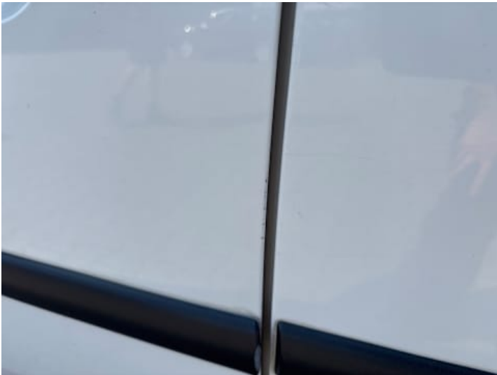
Fahrertür (Lackschaden, Kratzer)
