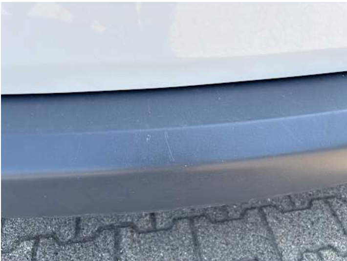
Stoßstange hinten (Kratzer, Verformung)
