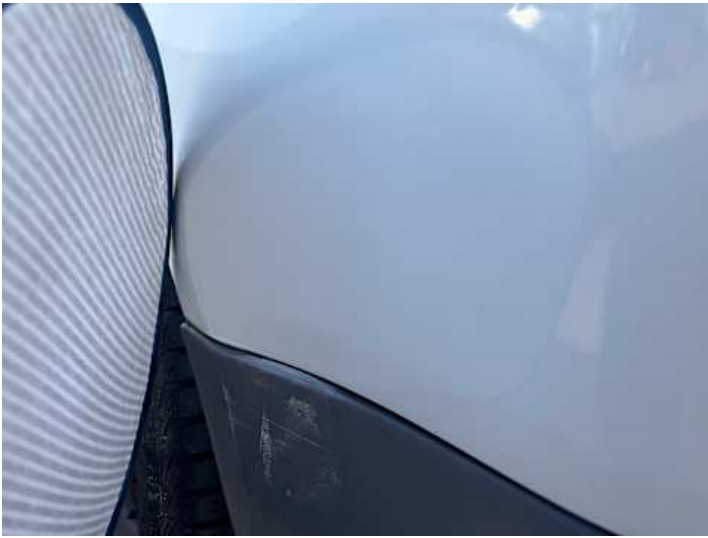
Seitenteil hinten links (Unsachgemäß instand gesetzt, Verformung, Rost)
