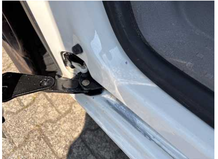
Schweller rechts (Lackschaden)
