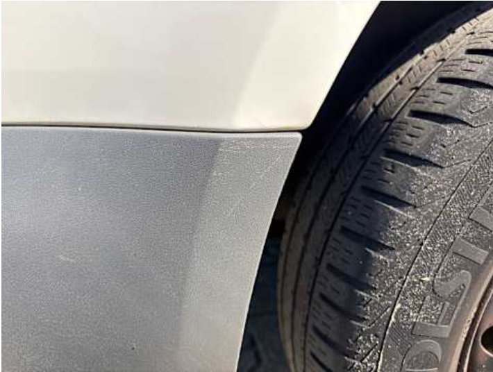
Stoßstange hinten (Kratzer, Verformung)
