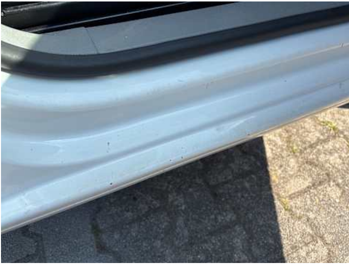
Schweller rechts (Lackschaden)
