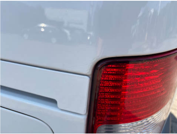
Seitenteil hinten links (Unsachgemäß instand gesetzt, Verformung, Rost)
