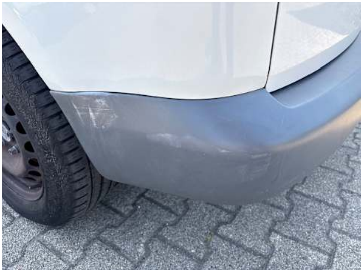
Stoßstange hinten (Kratzer, Verformung)
