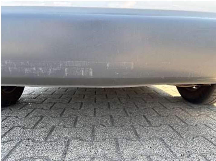
Stoßstange hinten (Kratzer, Verformung)
