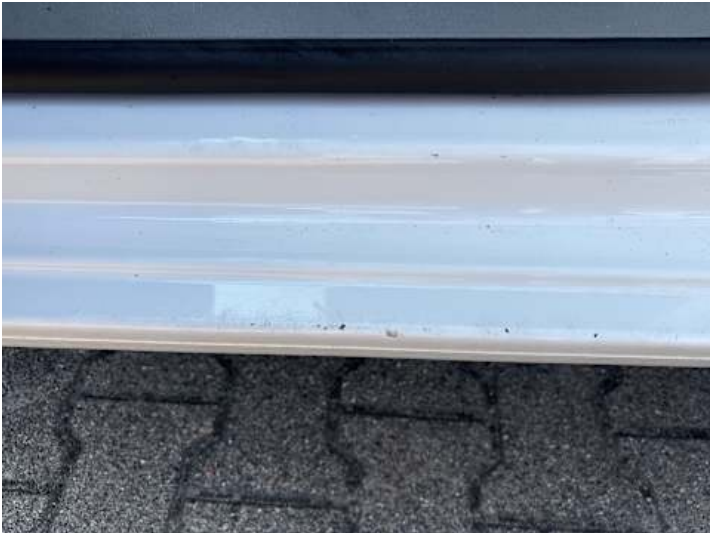
Schweller links (Lackschaden)
