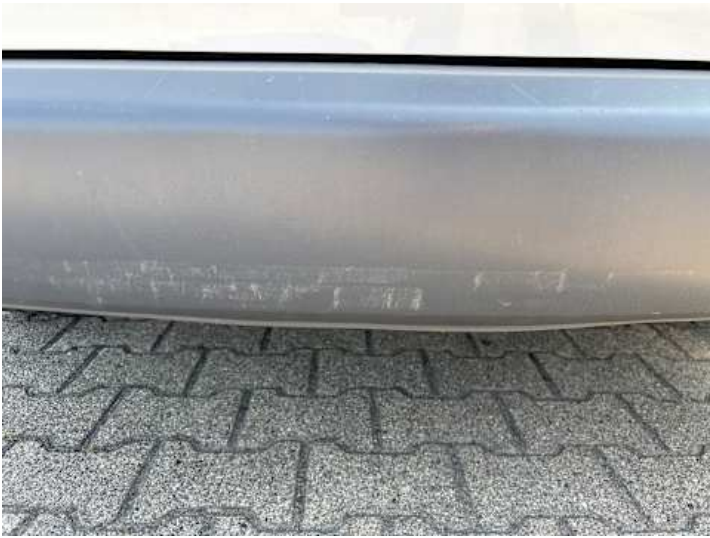
Stoßstange hinten (Kratzer, Verformung)
