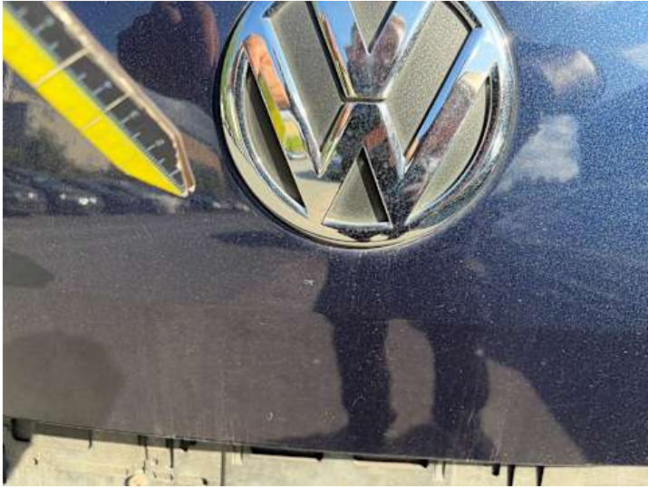
Heckklappe (Lackschaden, Kratzer)
