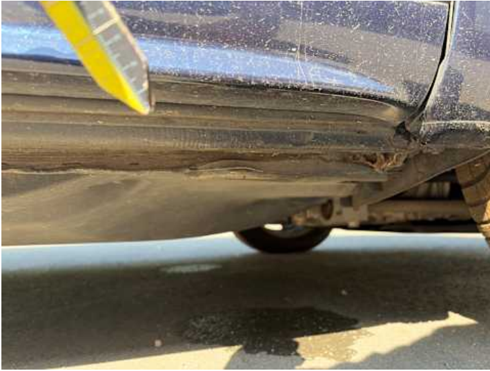
Schweller rechts (Lackschaden, Kratzer, Verformung)
