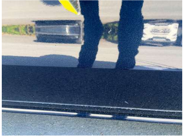
Türe hinten links (Lackschaden, Kratzer)
