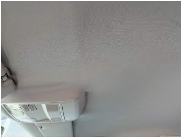
Innenraum (Verschmutzung, Anderer Schaden): Dachhimmel hängt runter
