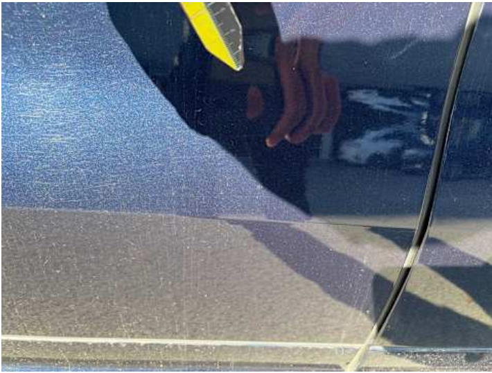
Türe hinten rechts (Lackschaden, Kratzer)
