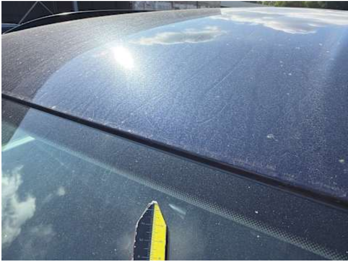
Dach (Lackschaden, Steinschlag)
