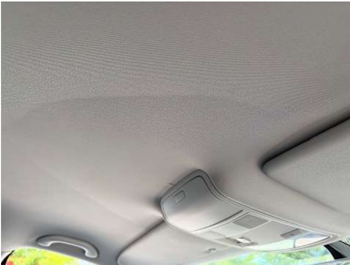
Innenraum (Verschmutzung, Anderer Schaden): Dachhimmel hängt runter
