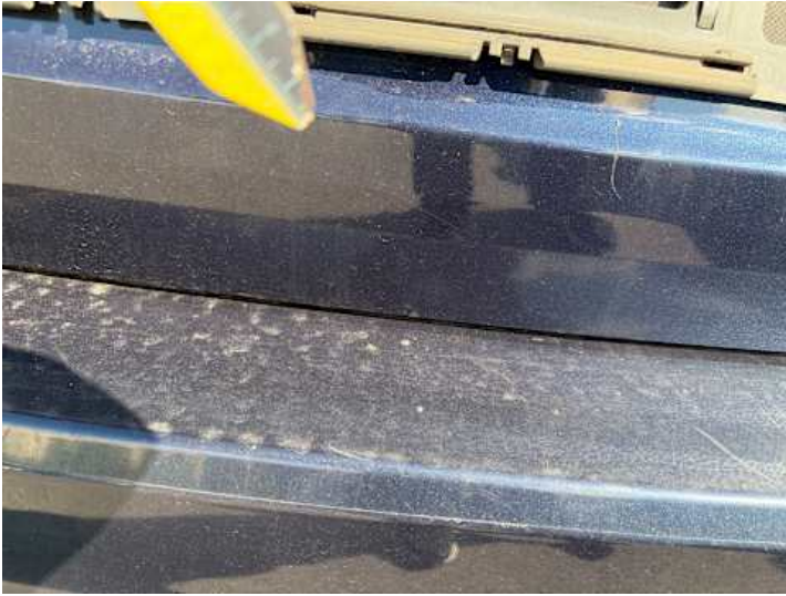
Heckklappe (Lackschaden, Kratzer)
