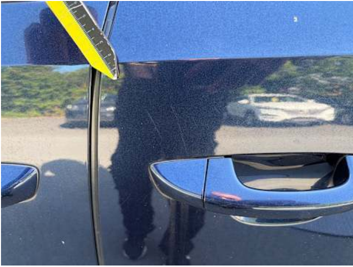
Türe hinten links (Lackschaden, Kratzer)
