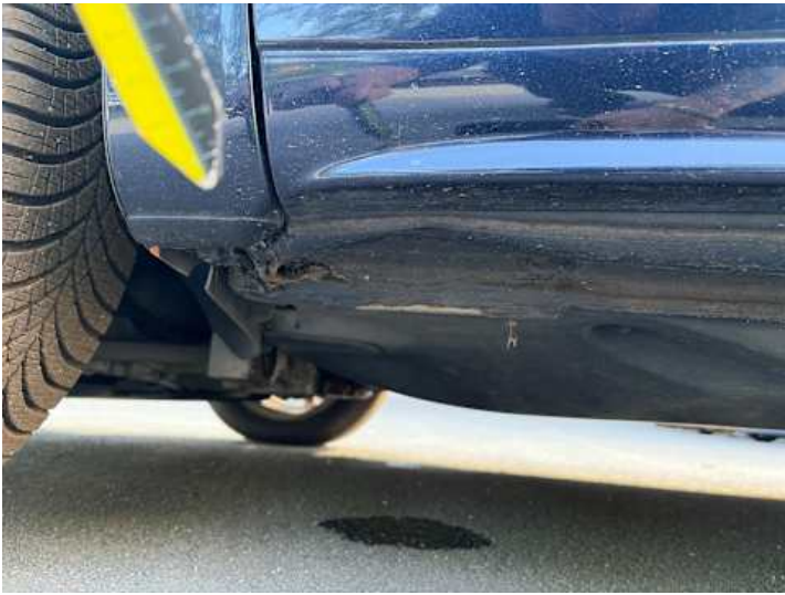
Schweller links (Lackschaden, Kratzer, Verformung)
