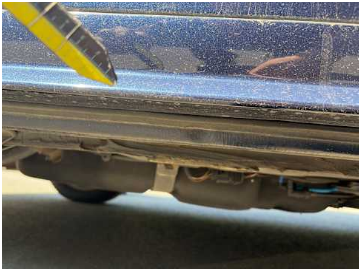
Schweller rechts (Lackschaden, Kratzer, Verformung)
