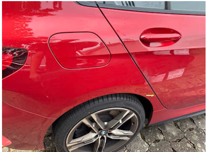
Seitenteil hinten rechts (Lackschaden)
