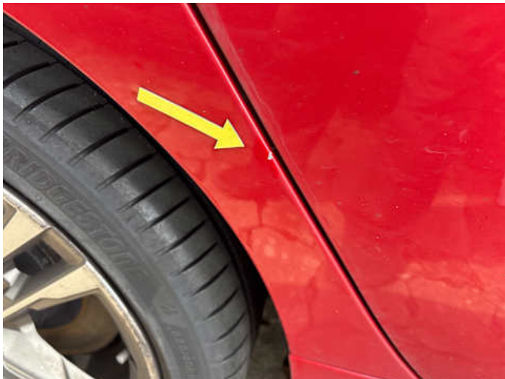
Seitenteil hinten rechts (Lackschaden)
