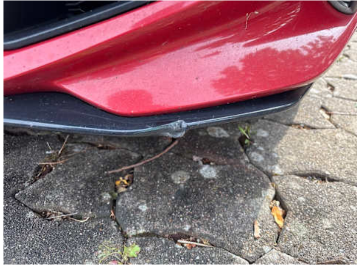
Stoßstange vorne (Lackschaden, Verformung)
