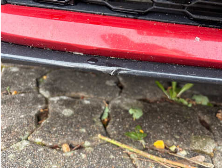
Stoßstange vorne (Lackschaden, Verformung)
