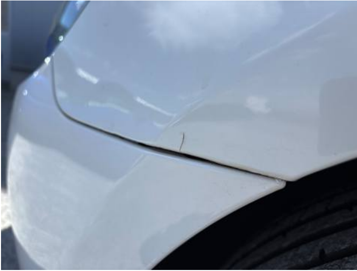
Kotflügel vorne links (Unsachgemäß instand gesetzt)
