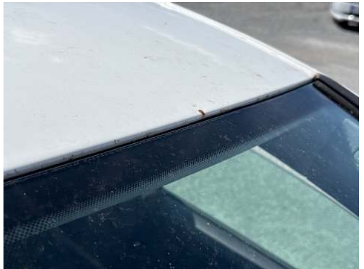
Dach (Rost, Steinschlag)
