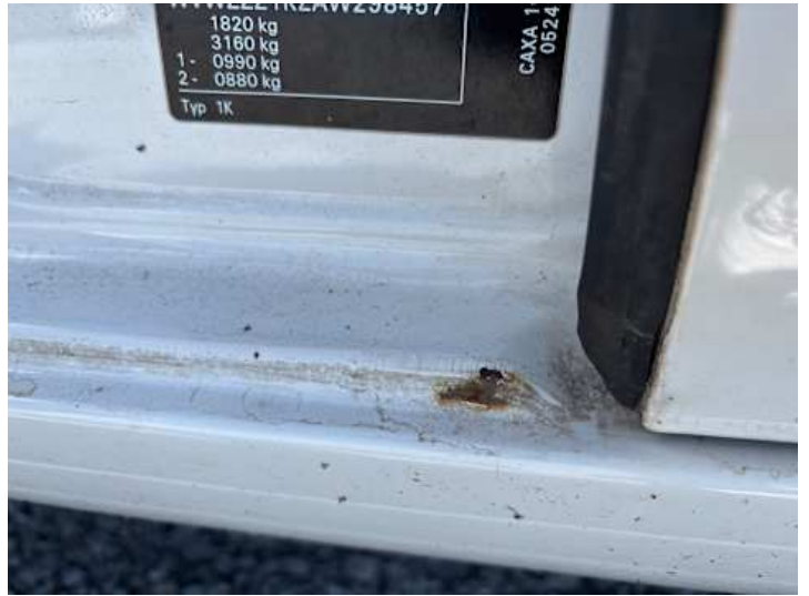
Fahrtür (Rost, Lackschaden)
