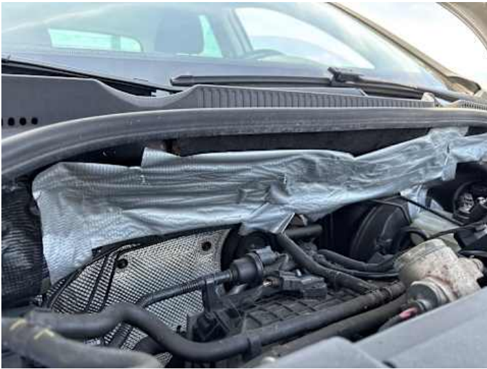
Motorhaube (Unsachgemäß instand gesetzt)
