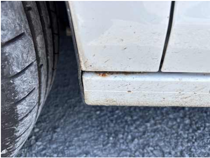
Schweller links (Rost)
