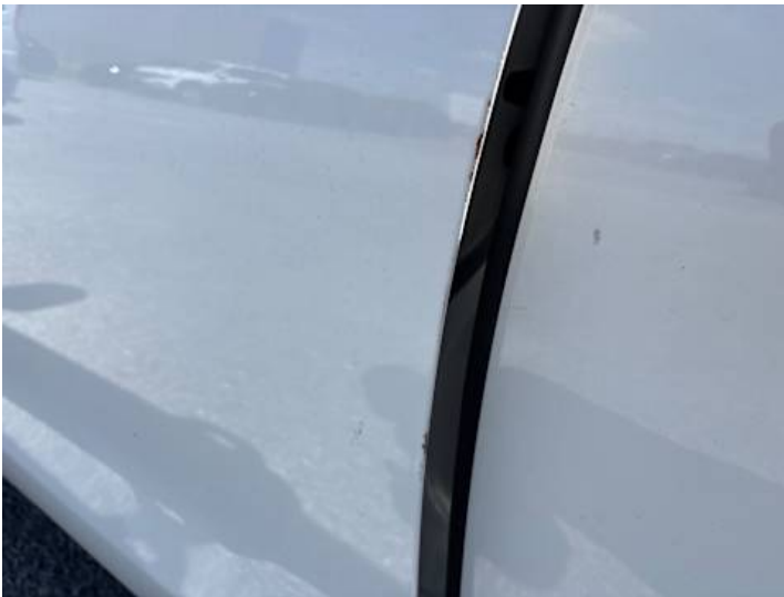
Fahrtür (Rost, Lackschaden)
