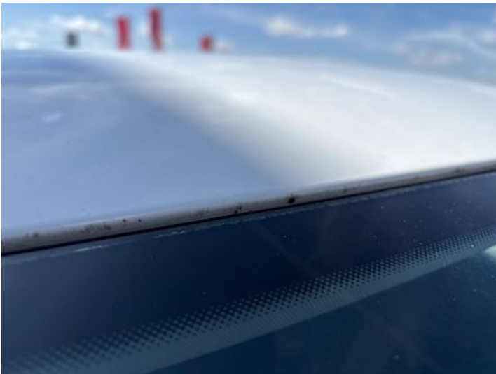
Dach (Rost, Steinschlag)
