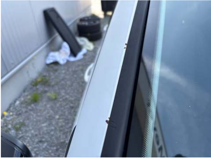
Seitenteil hinten rechts (Rost, Steinschlag)
