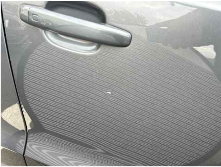
Beifahrertür (Delle, Kratzer)
