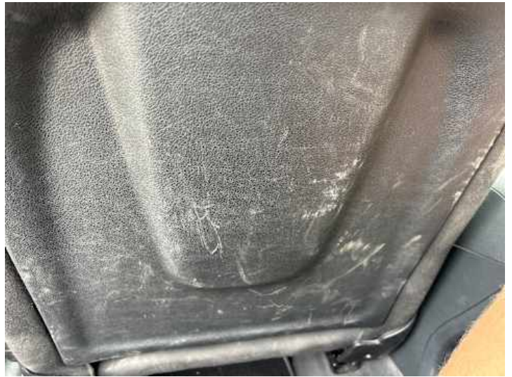
Innenraum (Kratzer, Verschleiß)
