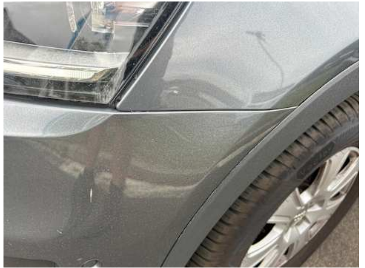
Stoßstange vorne (Spaltmaße ungenau)
