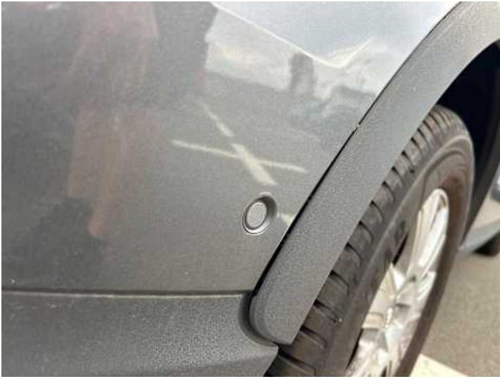
Stoßstange hinten (Spaltmaße ungenau)
