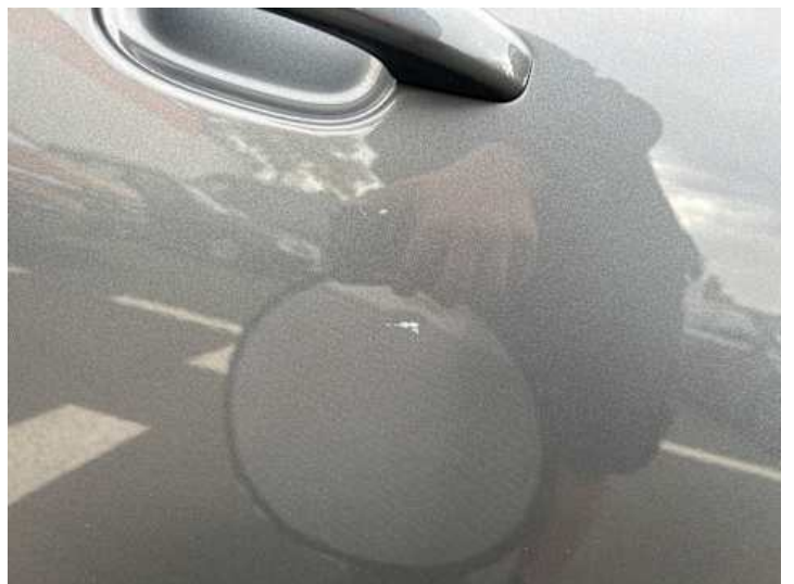
Beifahrertür (Delle, Kratzer)
