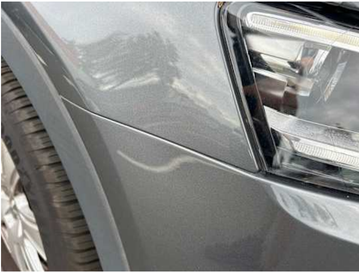
Stoßstange vorne (Spaltmaße ungenau)
