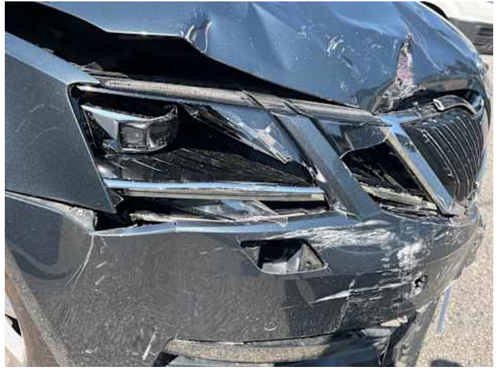
Scheinwerfer (rechts) (Riss/Bruch)
