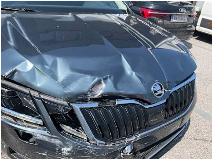
Motorhaube (Verformung, Lackschaden)
