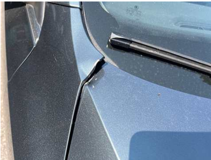
Motorhaube (Verformung, Lackschaden)
