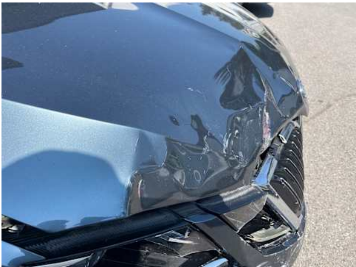
Motorhaube (Verformung, Lackschaden)
