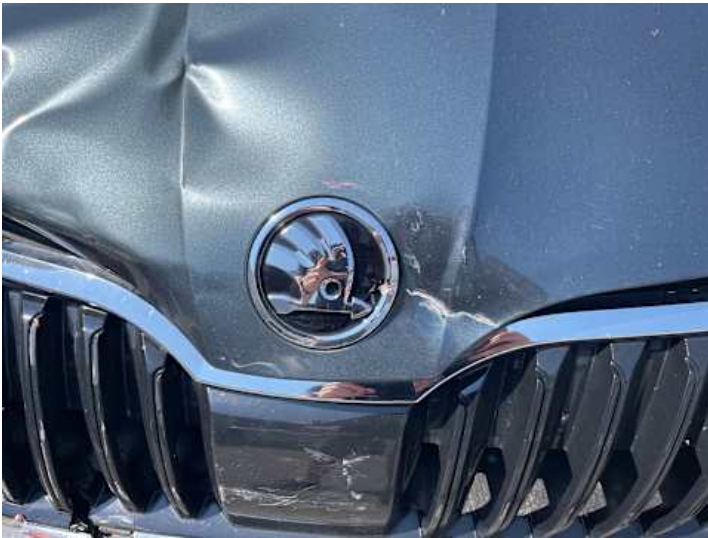
Motorhaube (Verformung, Lackschaden)
