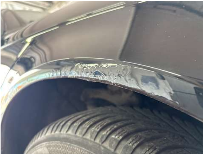
Kotflügel vorne rechts (Rost)
