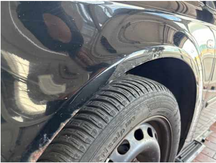
Kotflügel vorne links (Rost)
