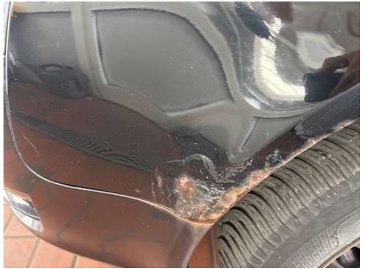
Kotflügel vorne links (Rost)
