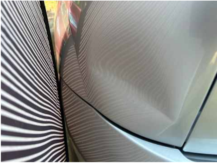
Seiten ­ teil hinten links (Verformung)
