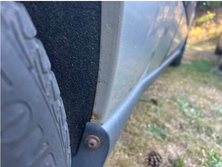
Seitenteil hinten rechts (Rost)
