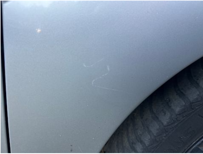
Kot ­ flügel vorne rechts (Kratzer, Lackschaden)
