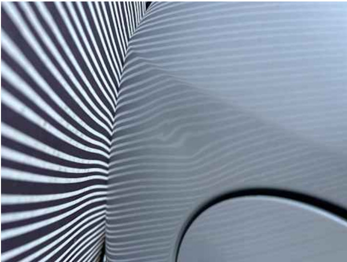
Seitenteil hinten rechts (Verformung)
