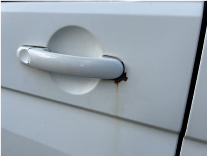
Türe hinten rechts (Lackschaden, Rost, Delle)
