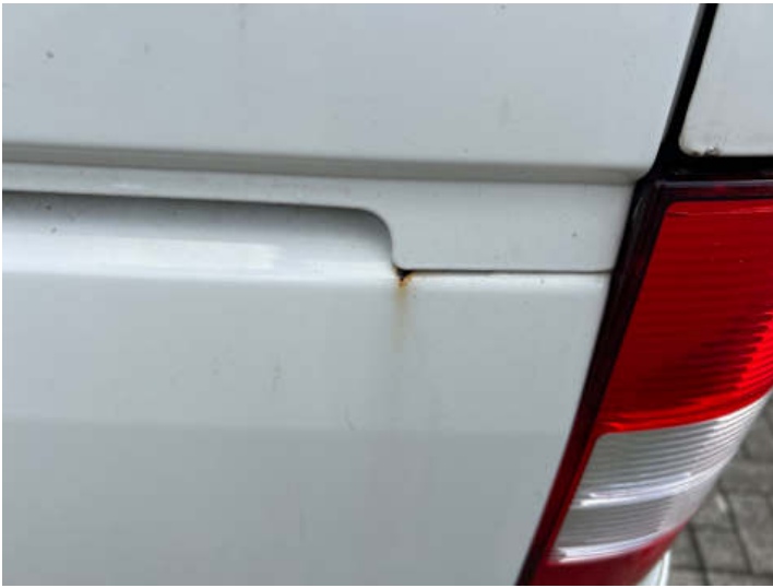
Seitenteil hinten links (Delle, Kratzer, Rost)
