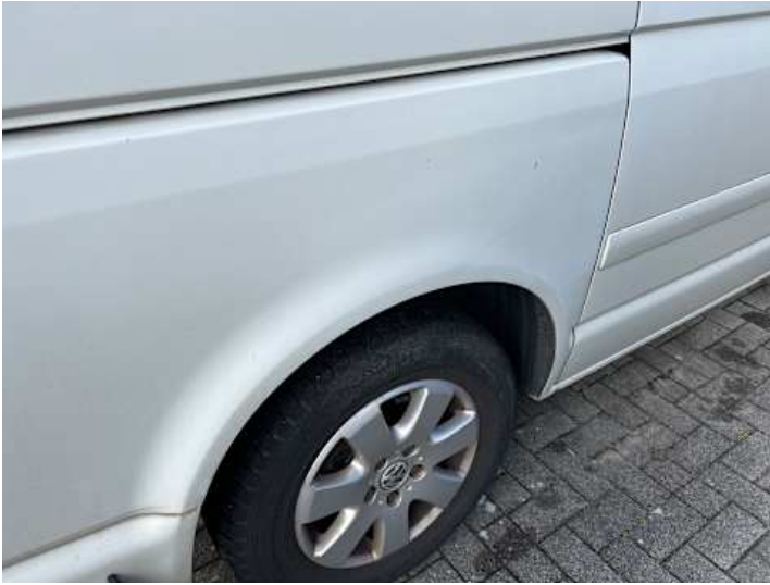
Seitenteil hinten rechts (Lackschaden, Unsachgemäß instand gesetzt)
