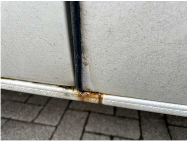
Beifahrertür (Kratzer, Rost, Delle, Lackschaden)
