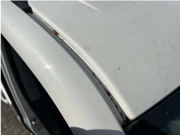
Dach (Delle, Lackschaden, Rost)
