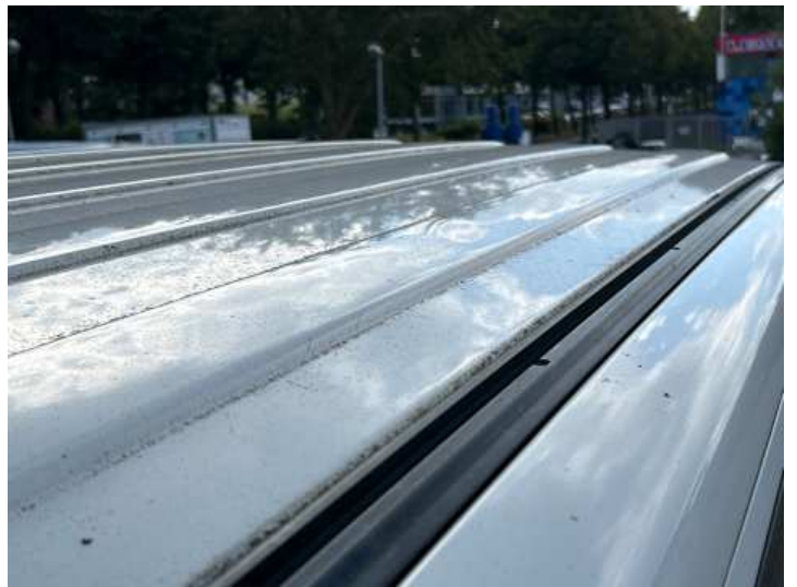
Dach (Delle, Lackschaden, Rost)
