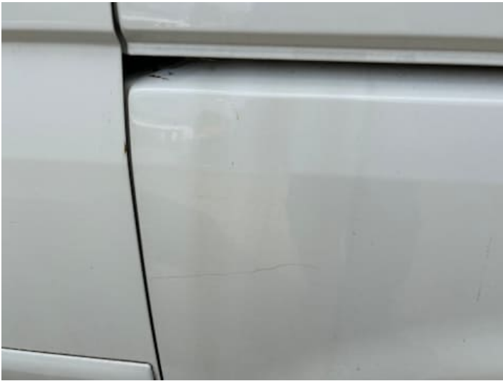
Seitenteil hinten links (Delle, Kratzer, Rost)
