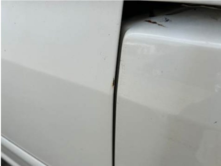
Türe hinten links (Lackschaden, Kratzer, Rost)
