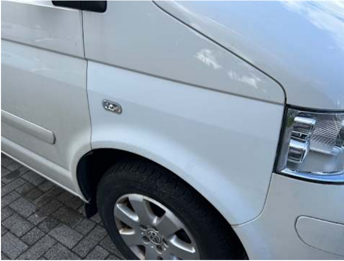
Kotflügel vorne rechts (Lackschaden, Unsachgemäß instand gesetzt)
