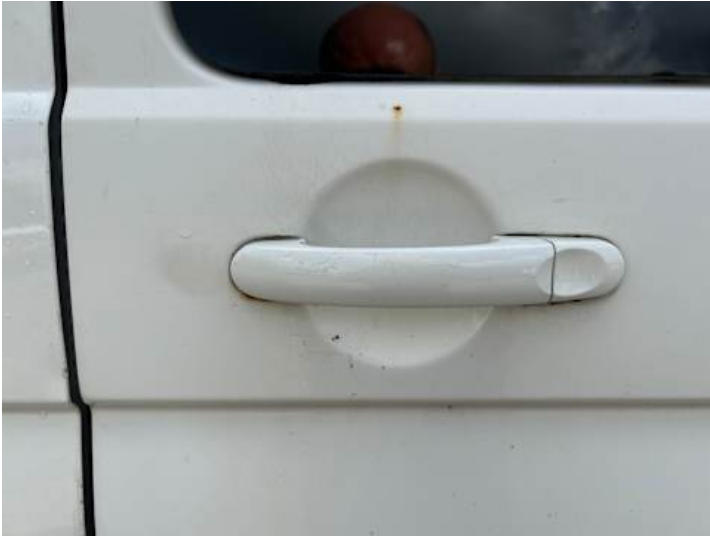
Türe hinten links (Lackschaden, Kratzer, Rost)
