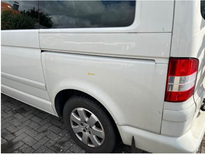
Seitenteil hinten links (Delle, Kratzer, Rost)
