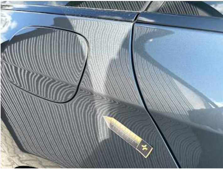
Seitenteil hinten rechts (Delle, Unsachgemäß instand gesetzt)
