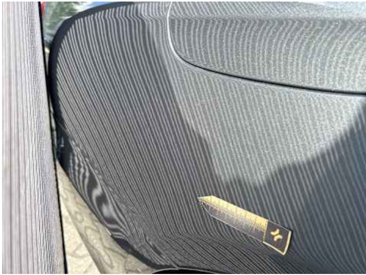
Seitenteil hinten rechts (Delle, Unsachgemäß instand gesetzt)
