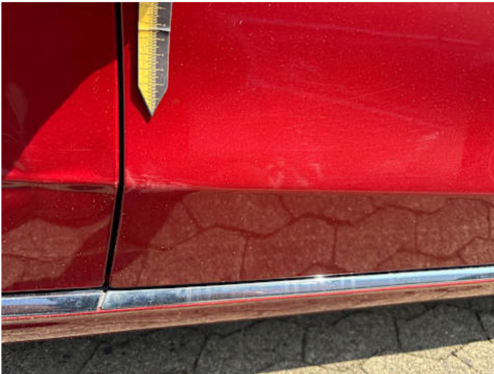
Beifahrer ­ tür (Kratzer, Delle, Lackschaden)
