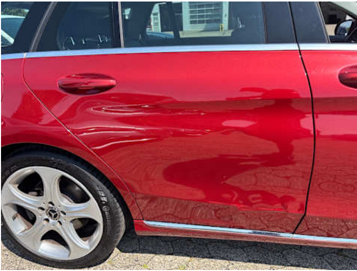
Türe hinten rechts (Verformung, Delle)
