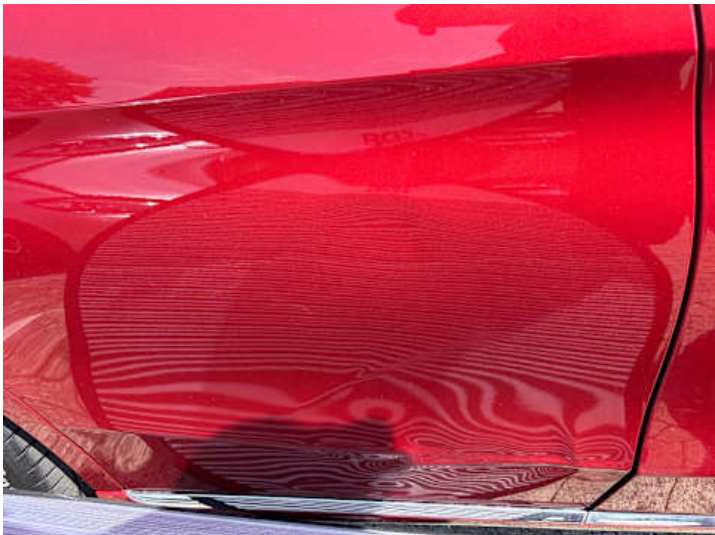
Türe hinten rechts (Verformung, Delle)
