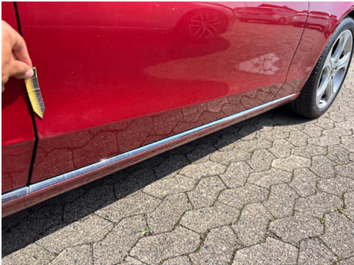
Beifahrer ­ tür (Kratzer, Delle, Lackschaden)
