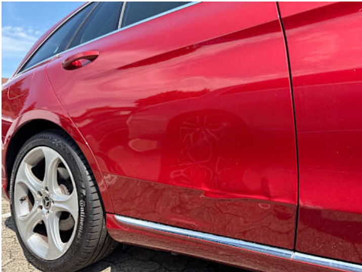
Türe hinten rechts (Verformung, Delle)
