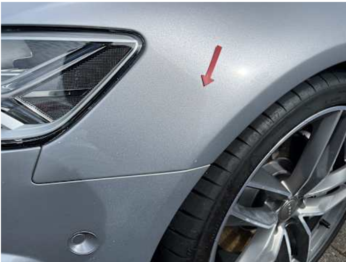
Kotflügel vorne links (Steinschlag)
