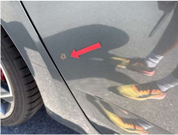
Türe hinten rechts (Rost)
