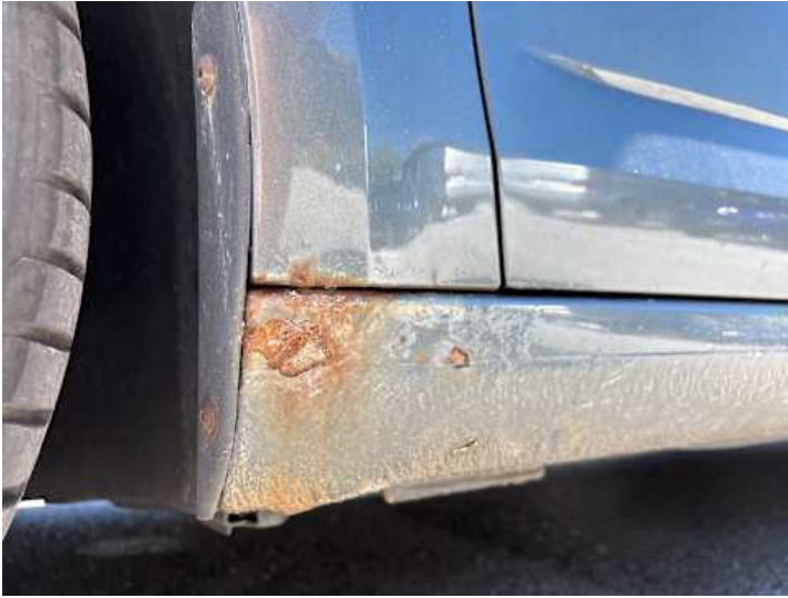
Schweller links (Rost)
