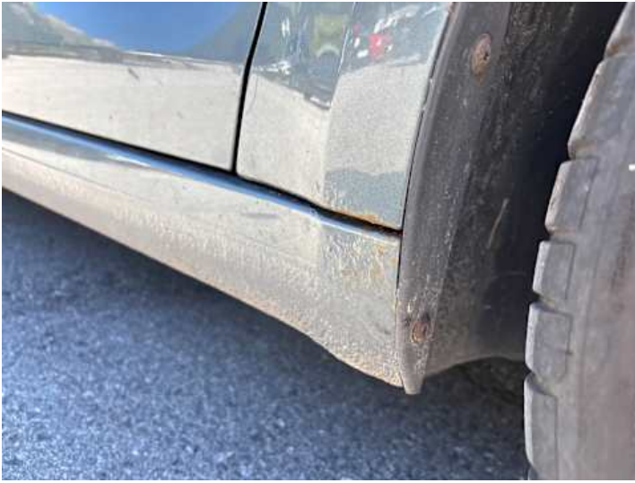
Schweller rechts (Rost)
