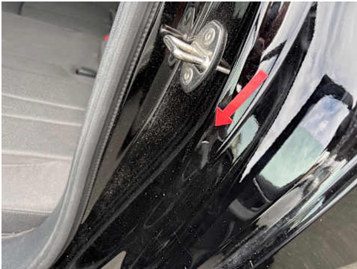
Türe hinten links (Lackschaden)
