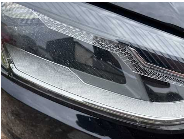
Scheinwerfer (rechts) (Steinschlag)
