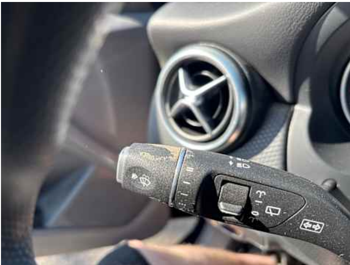
Innenraum (Verschmutzung, Verschleiß)
