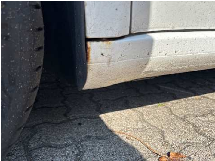
Schweller links (Rost)
