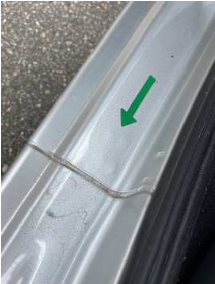
Schweller links (Delle)
