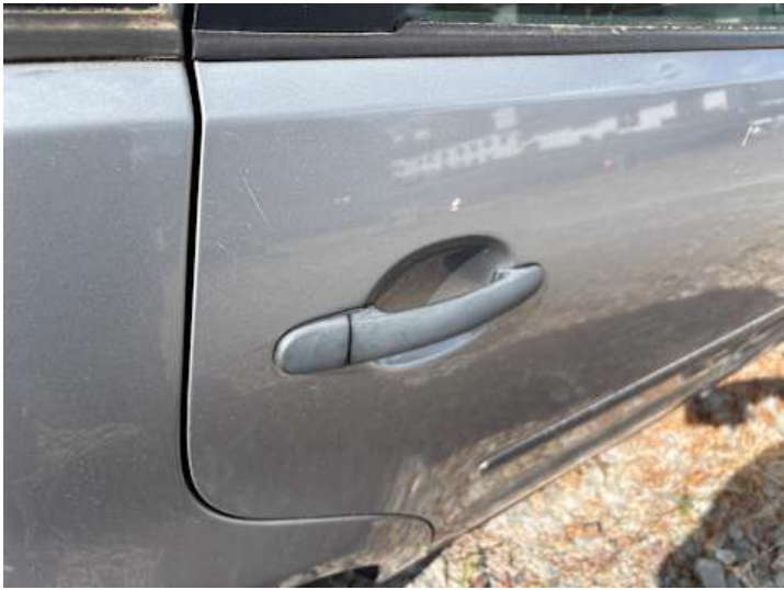
Türe hinten rechts (Kratzer)
