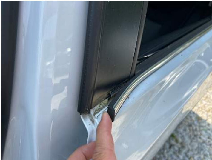
Türe hinten links (Riss/Bruch)
