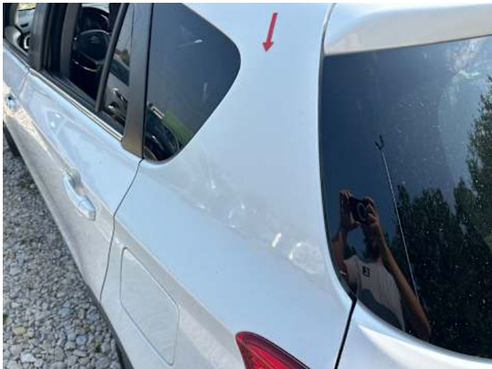
Seitenteil hinten links (Unsachgemäß instand gesetzt)
