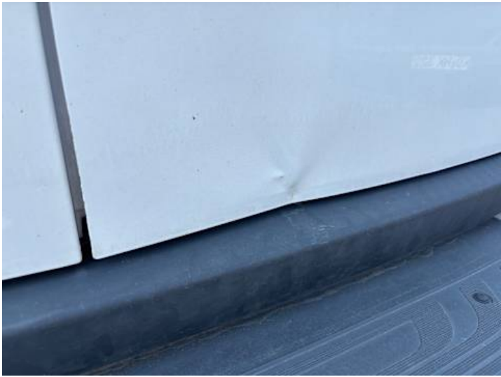
Heckklappe (Kratzer, Delle)
