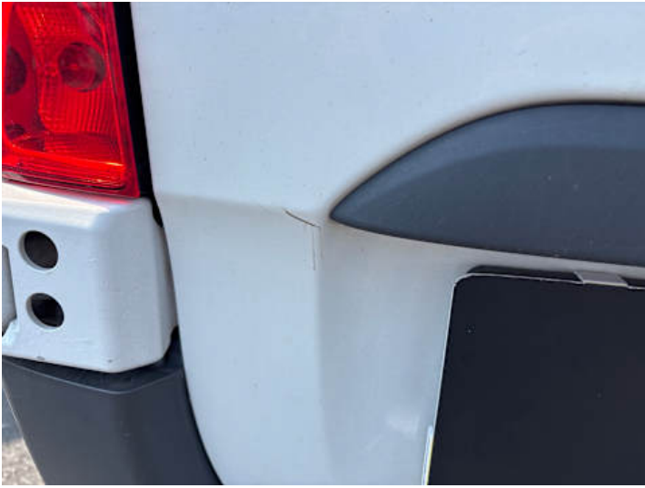
Heckklappe (Kratzer, Delle)
