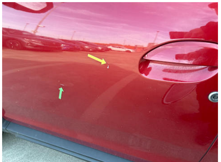
Fahrtür (Kratzer, Delle)
